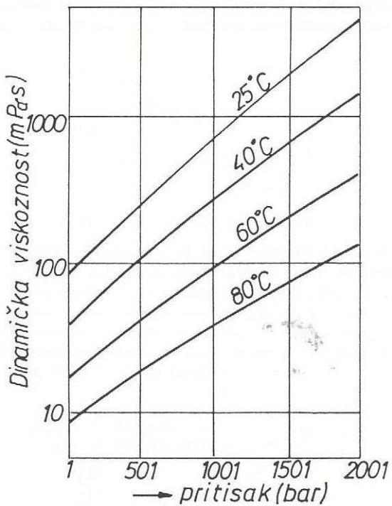
Slika 3.7: Promjena dinamičke viskoznosti u odnosu na promjenu temperature i tlaka
