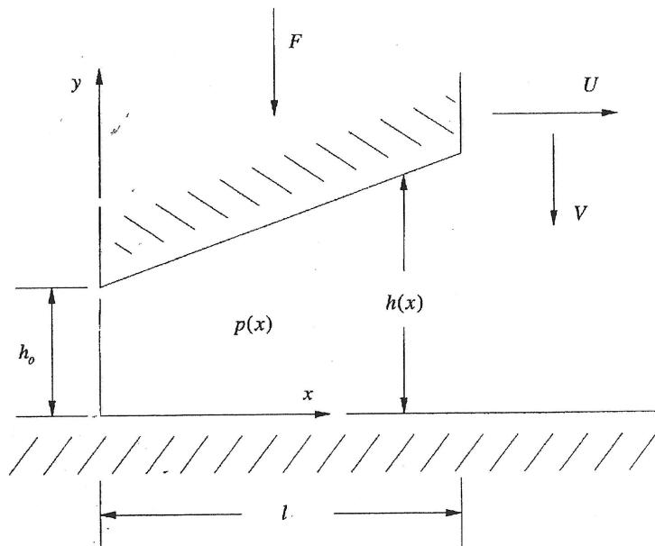
Slika 3.20: Podmazivanje nakošenog jastuka ležaja
