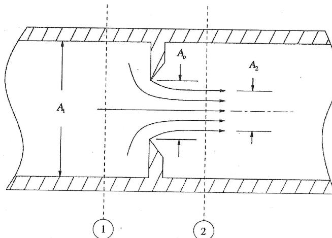
Slika 3.8: Strujanje visokim Reynoldsovim brojem kroz otvor  $A_2$
