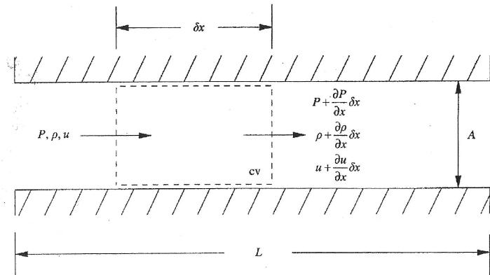
Slika 3.18: Analiza kontrolnog volumena za hidrauličke cijevi
