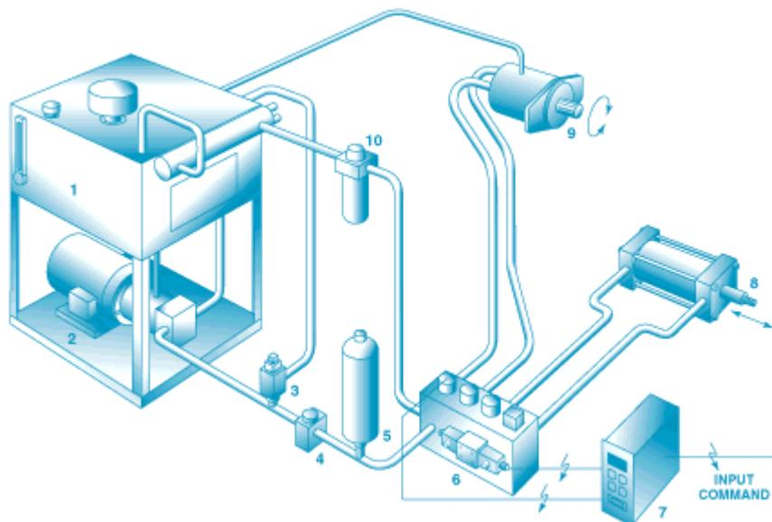
Hidraulički sustavi s vodom koriste sve osnovne vrste komponenti kao i kod konvencionalnih sustava, pumpe, motori, cilindri, ventilii, filtri i akumulatori. Međutim, ove komponente su dizajnirane da izdrže zahtjevnije uvijete koje je izazvalo uvođenje vode. Posebni materijali, nehrđajući čelik, keramika te razni polimeri, kombinirani sa strožim tolerancijama daju komponente koje performansama odgovaraju konvencionalnim komponentama.
