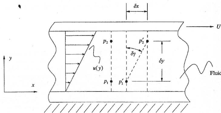
Slika 3.4: Shematski prikaz posmične deformacije unutar fluida
