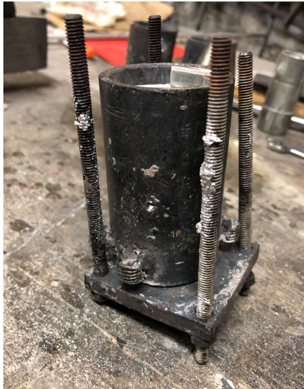
Slika 48 Kalup s prekursorom za izradu metalne pjene
