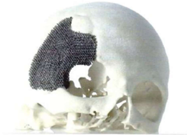
Slika 21 Prototip nadomjestka ljudske kosti od Ti-6Al-4V legure proizveden pomoću postupka taljenja snopom elektrona [12]
