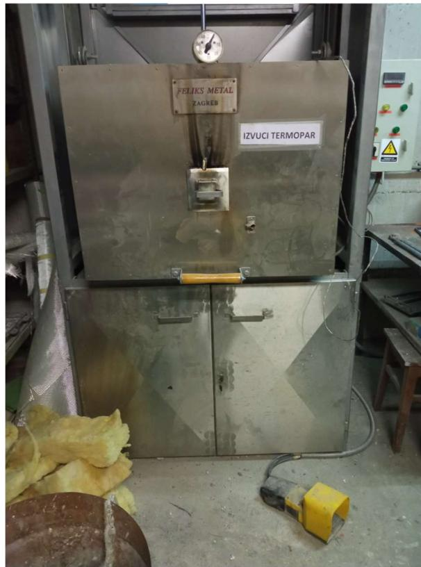
**Slika 49 Elektrootporna zvonasta peć**
