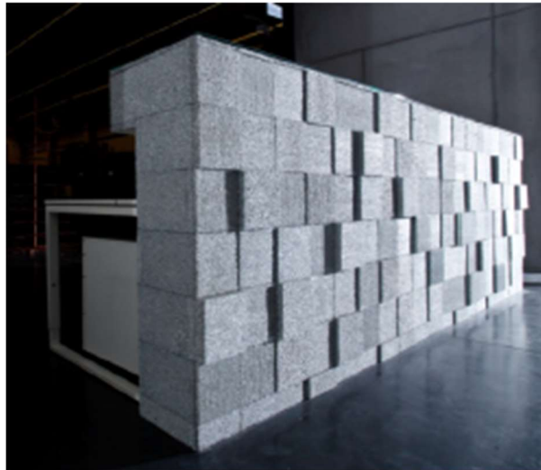
Slika 35 Recepcija poslovne zgrade od aluminijeve pjene [14]
