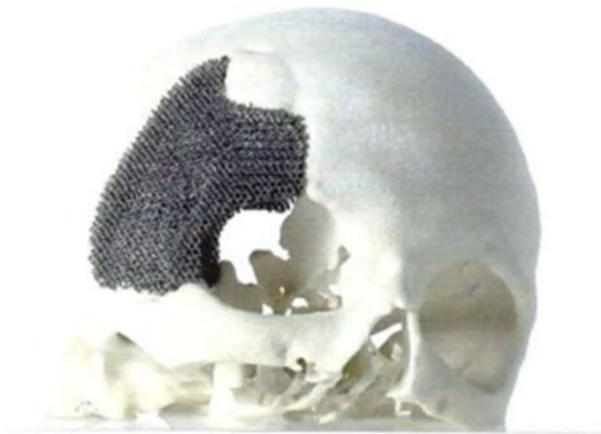
**Slika 21 Prototip nadomjestka ljudske kosti od Ti-6Al-4V legure proizведен pomoću postupka taljenja snopom elektrona [12]**
