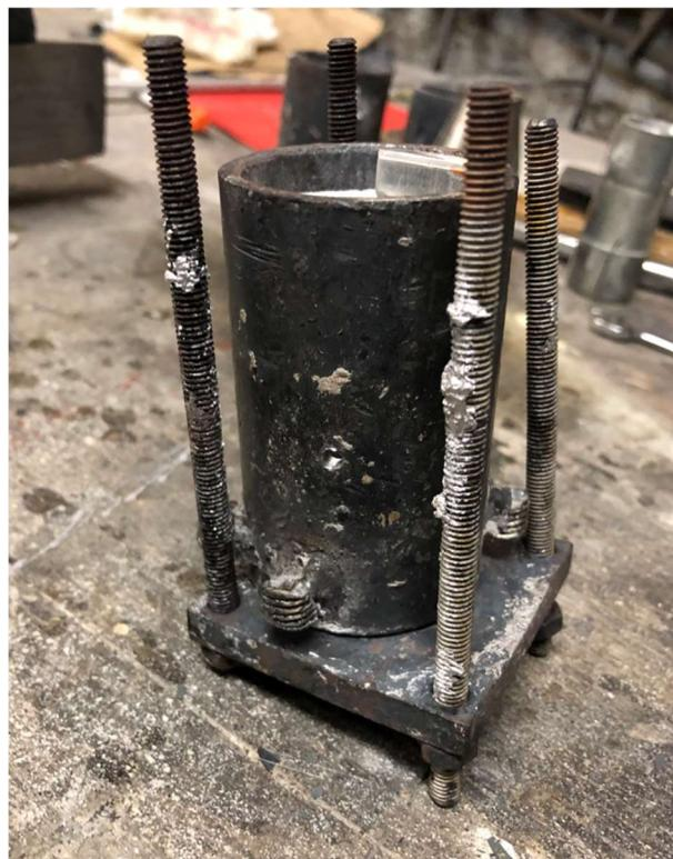
**Slika 48    Kalup s prekursorom za izradu metalne pjene**
