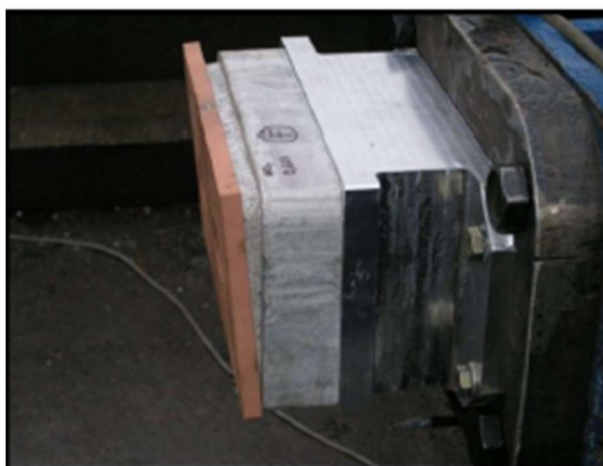
Slika 26 Blok od metalne pjene na braniku vlaka [14]
