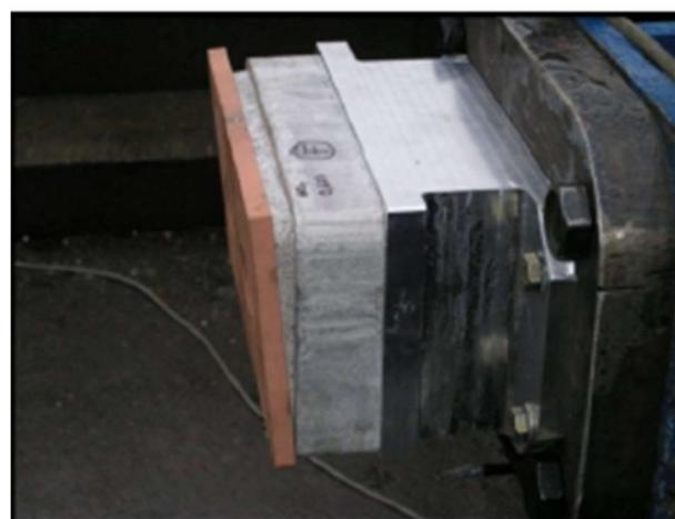
Slika 26 Blok od metalne pjene na braniku vlaka [14]
