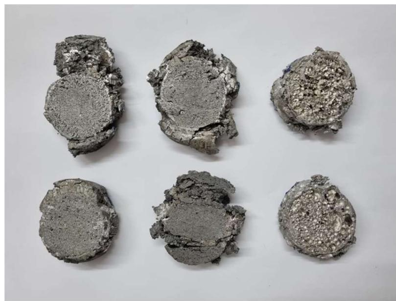
Slika 128 Uzorci nakon tlačnog ispitivanja
