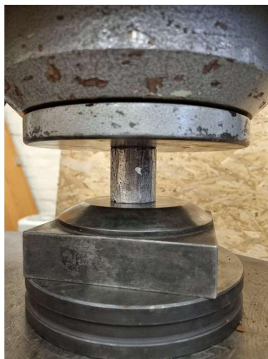
Slika 127 Tlačno ispitivanje uzorka
