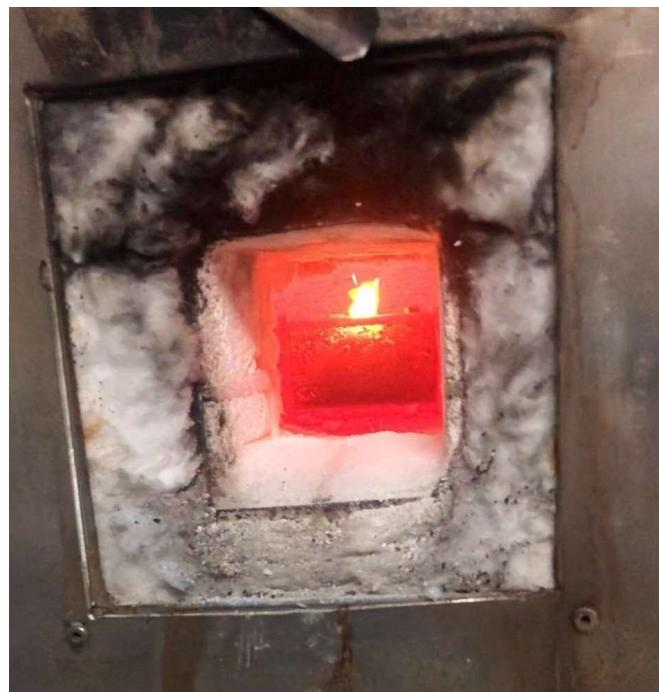
Slika 50 Izlazak pjene iz kalupa
