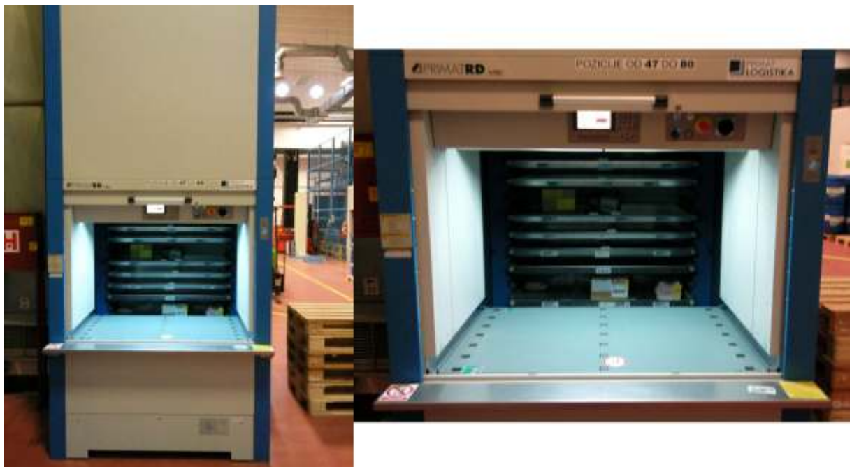
Slika 22. VLM Kardex Shuttle instaliran u skladišnom sustavu Belupa d.d.
