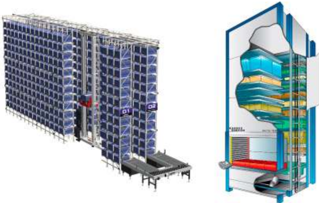
Slika 24. Usporedba mini-load AS/RS sustava i VLM-a [7], [8]
