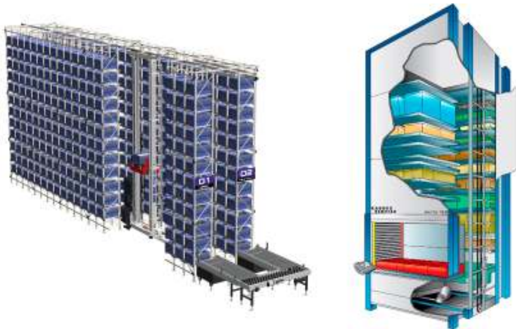
Slika 24. Usporedba mini-load AS/RS sustava i VLM-a [7], [8]
