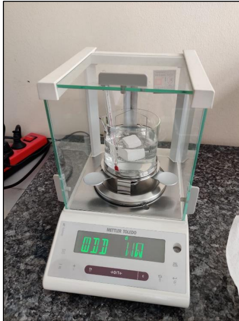
Slika 24. Arhimedova vaga Mettler Toledo (Mettler Toledo GmbH, Švicarska) s dodatkom za mjerenje gustoće i uzorkom.
