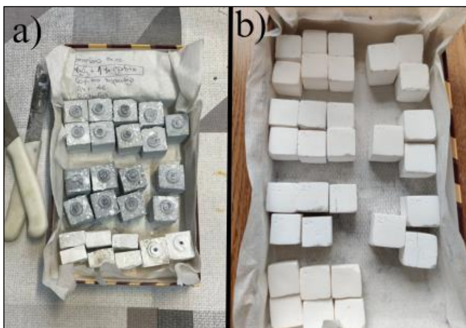
Slika 21. (a) Sirovci dobiveni nakon lijevanja suspenzija i (b) sirovci nakon brušenja.
