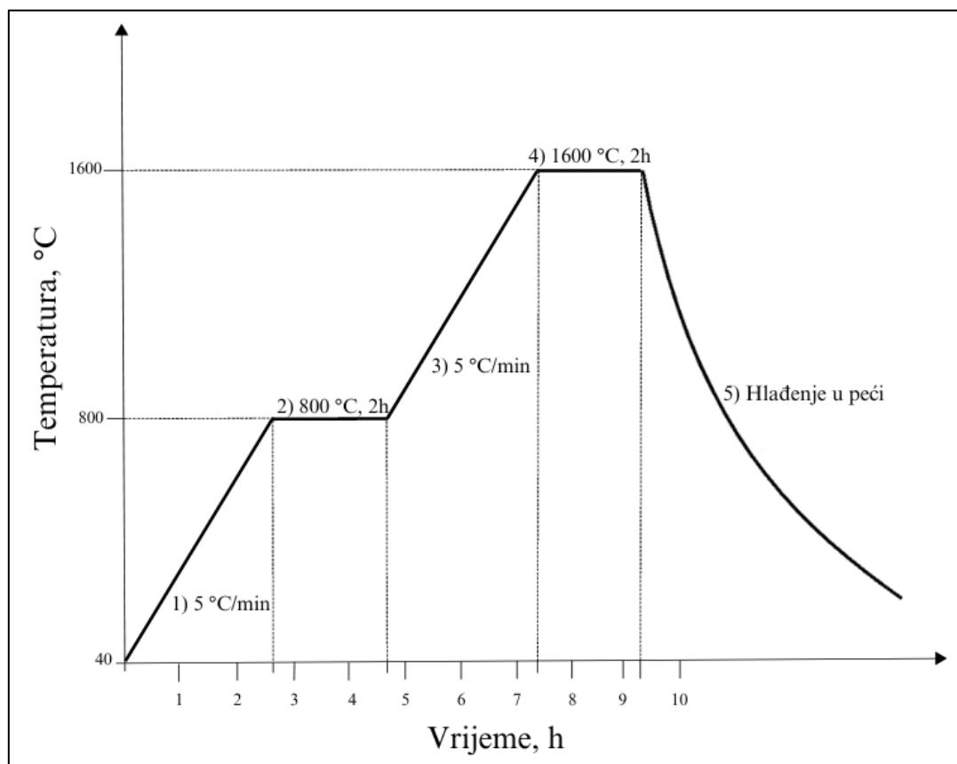
Slika 22. Režim sinteriranja u električnoj peći s označenim koracima.
