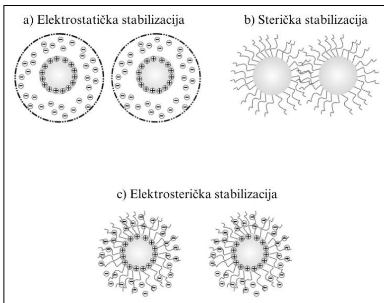
**Slika 10. Shematski prikaz stabilizacije keramičkih suspenzija (a) elektrostatička, (b) sterička i (c) elektrosterička stabilizacija [12].**
