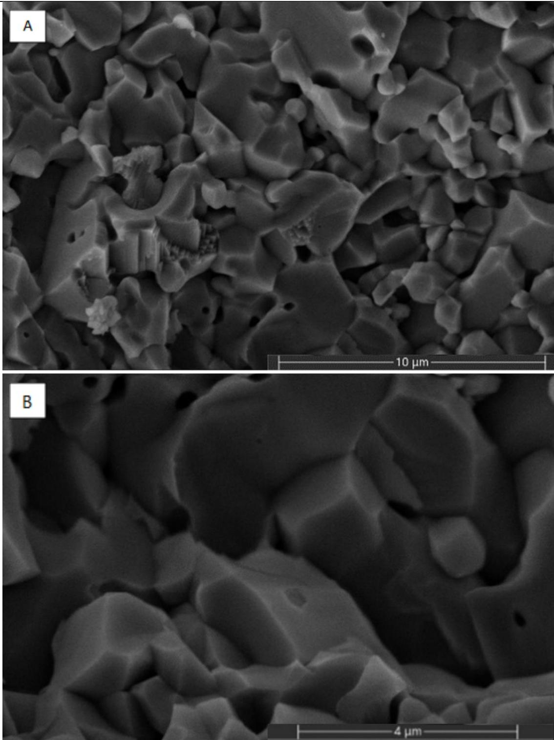
Slika 27. SEM snimke površine uzorka  $\text{Al}_2\text{O}_3$  keramike s dodatkom 1 % grafita sinteriranog u električnoj peći na  $1650^\circ\text{C}$ , pri različitom povećanju: (A)  $5000 \times$  i (B)  $10000 \times$ .
