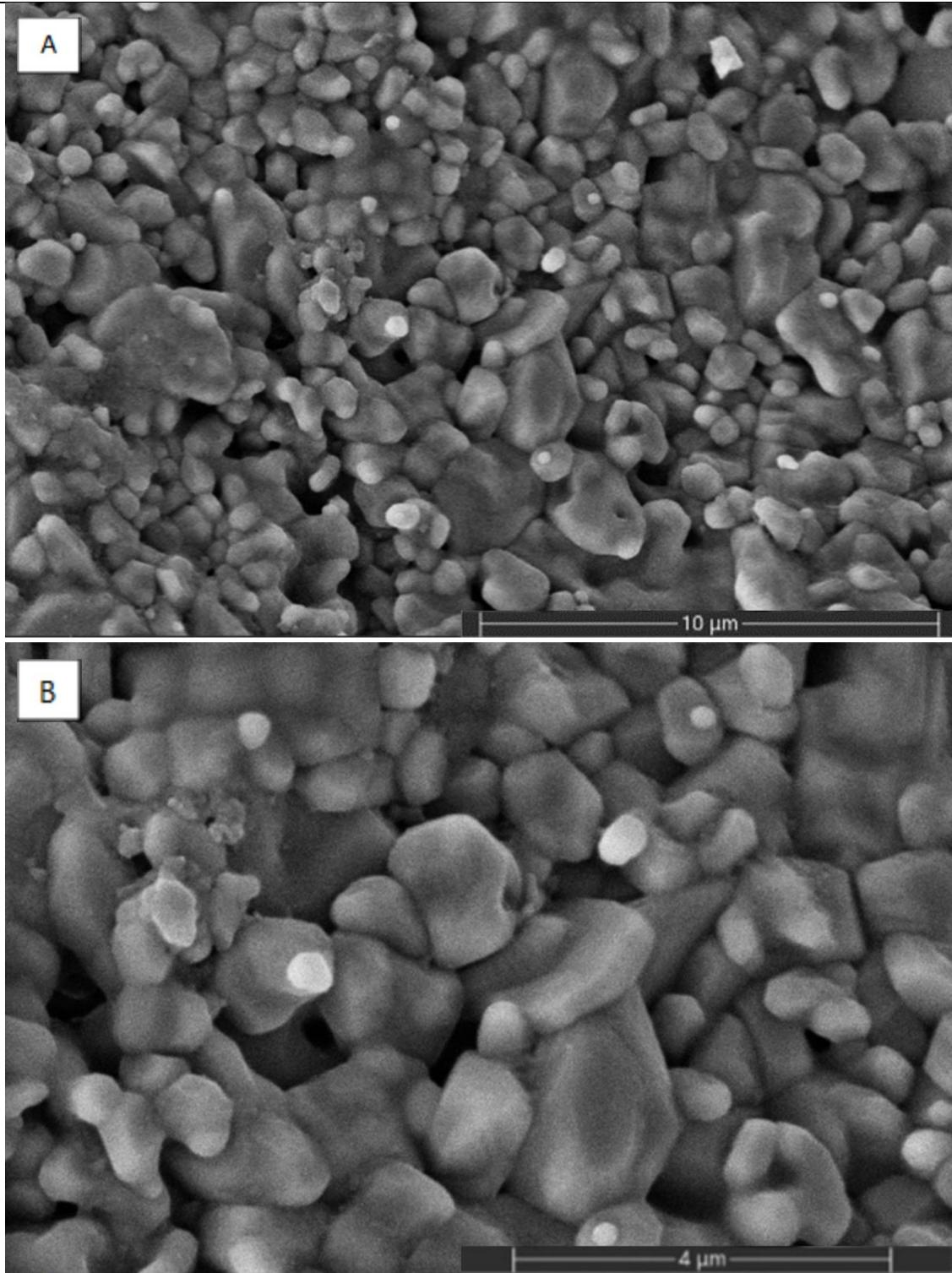
Slika 29. SEM snimke površine uzorka  $\text{Al}_2\text{O}_3$  keramike s dodatkom 10 % grafita sinteriranog u električnoj peći na  $1650^\circ\text{C}$ , pri različitom povećanju: (A)  $5000 \times$  i (B)  $10000 \times$ .
