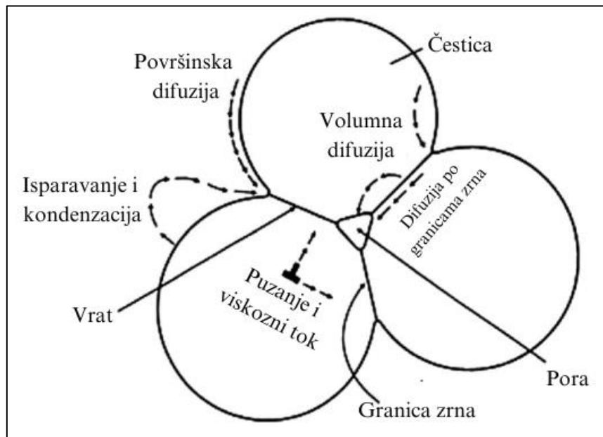
**Slika 13.** Shematski prikaz atomskih mehanizama sinteriranja [18].
