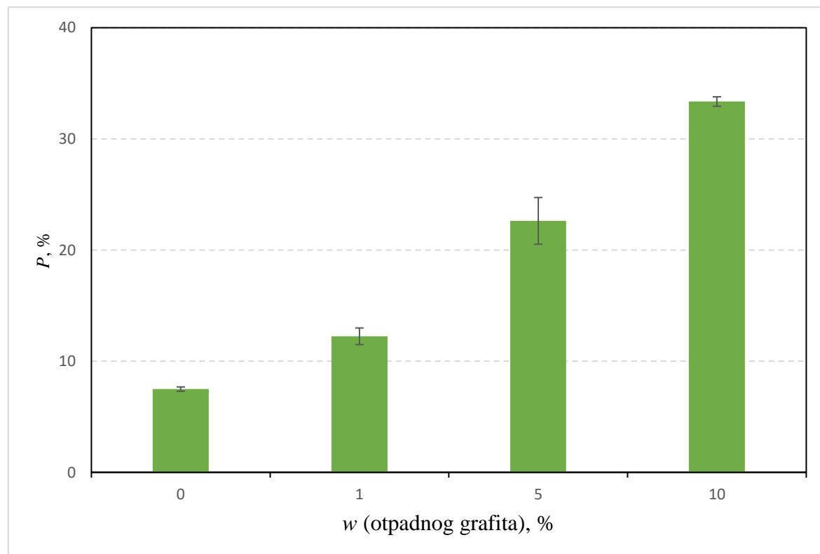
**Slika 32.** Promjena poroznosti (P, %) uzorka  $\text{Al}_2\text{O}_3$  keramike u ovisnosti o različitim masenim udjelima otpadnog grafita (0, 1, 5 i 10 %).
