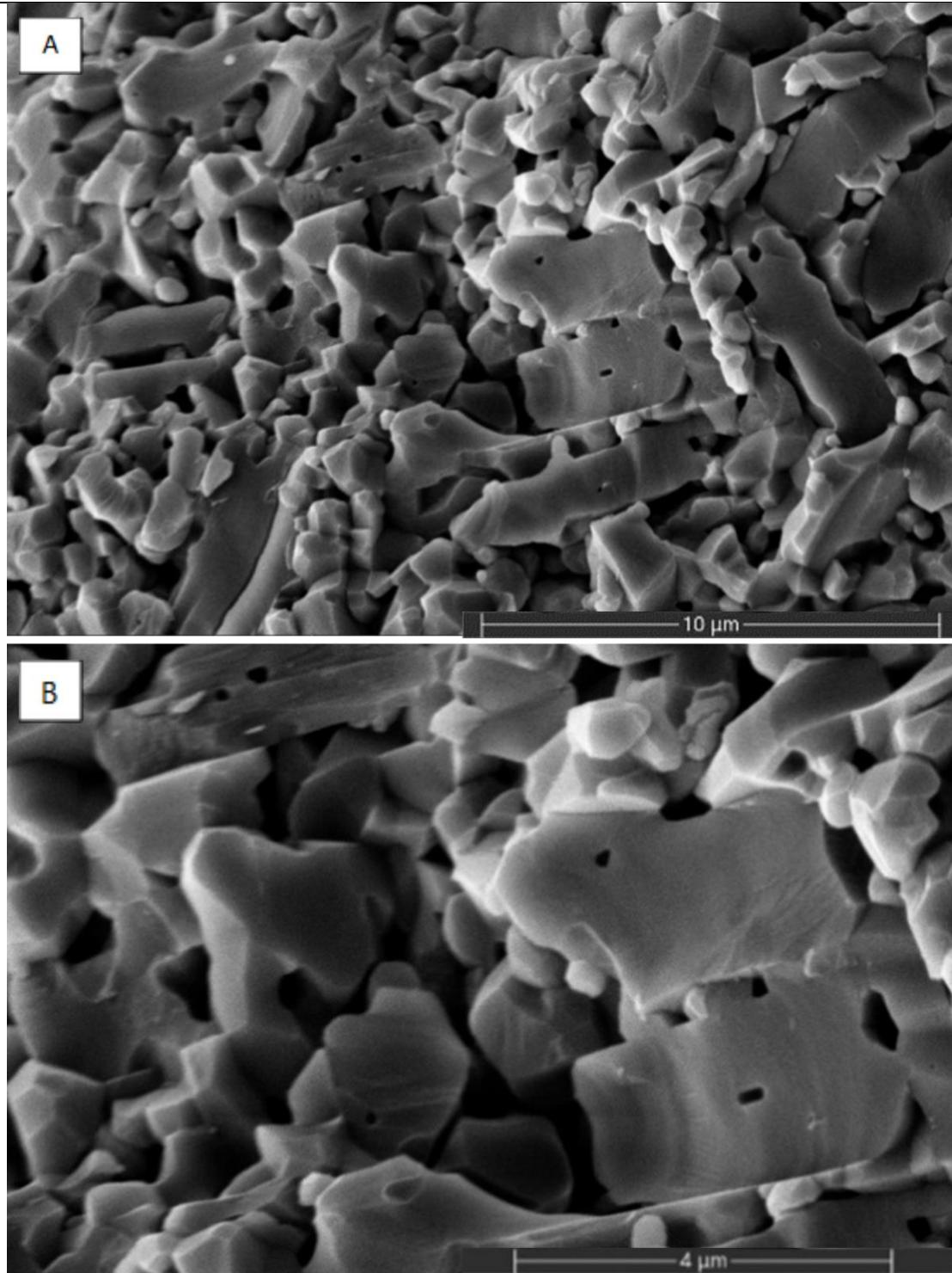
Slika 28. SEM snimke površine uzorka  $\text{Al}_2\text{O}_3$  keramike s dodatkom 5 % grafita sinteriranog u električnoj peći na  $1650^\circ\text{C}$ , pri različitom povećanju: (A)  $5000 \times$  i (B)  $10000 \times$ .
