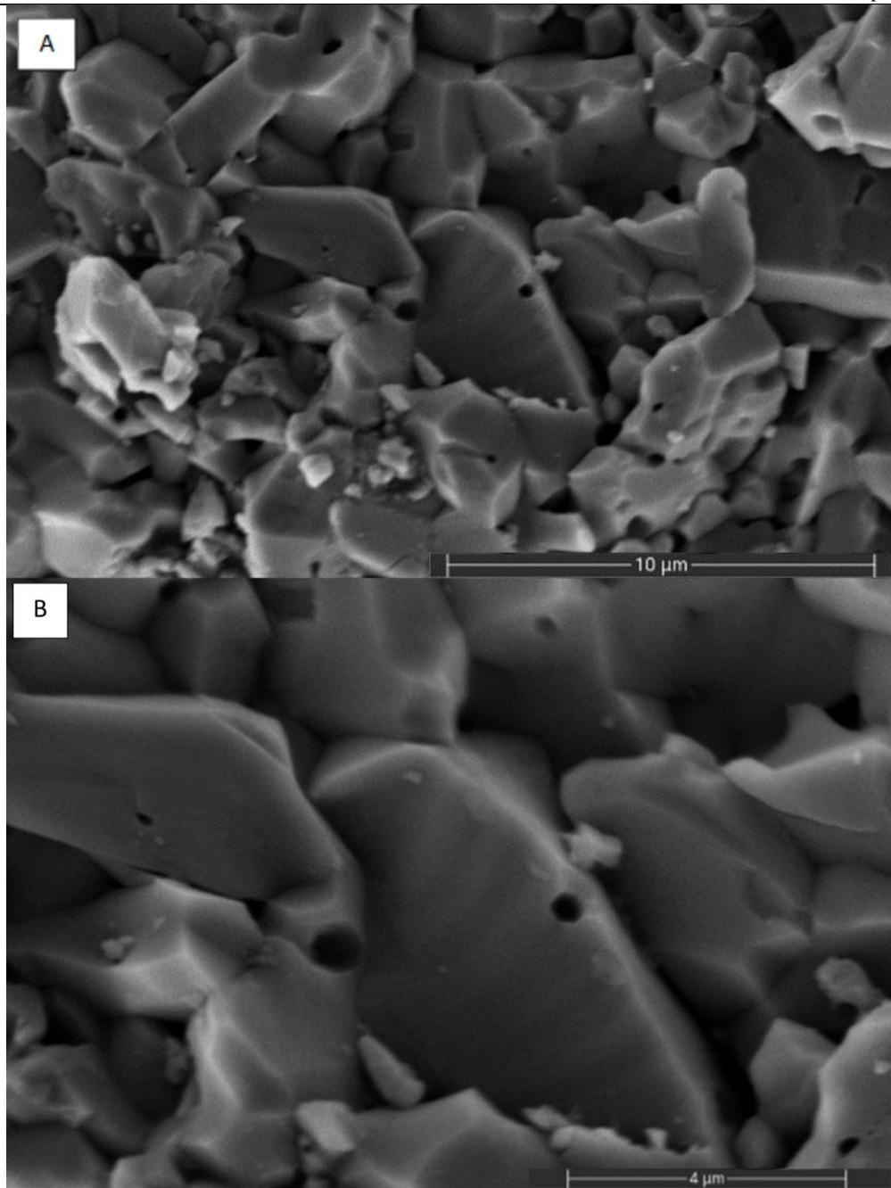
Slika 26. SEM snimke površine uzorka  $\text{Al}_2\text{O}_3$  keramike s dodatkom 0 % grafita sinteriranog u električnoj peći na  $1650^\circ\text{C}$ , pri različitom povećanju: (A)  $5000 \times$  i (B)  $10000 \times$ .
