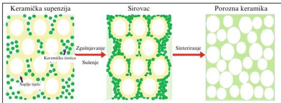
**Slika 7. Shematski prikaz postupka sinteriranja šupljih tijela [2].**
