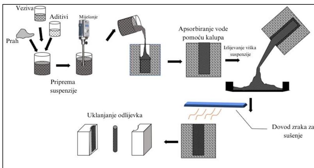
Slika 9. Shematski prikaz oblikovanja keramike postupkom lijevanja suspenzije [9].
