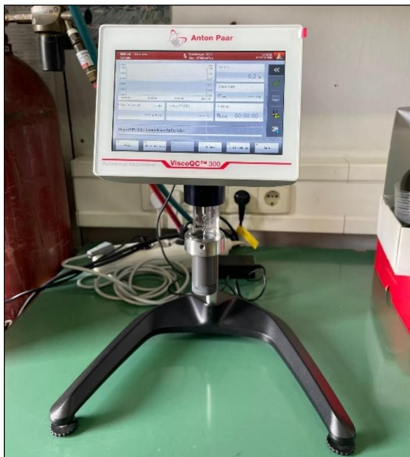
Slika 20. Viskozimetar – Anton Paar ViscoQC 300.
