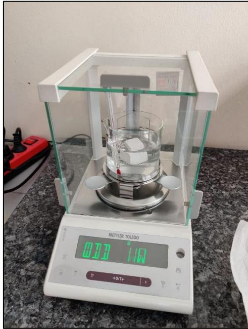
**Slika 24.** Arhimedova vaga Mettler Toledo (Mettler Toledo GmbH, Švicarska) s dodatkom za mjerjenje gustoće i uzorkom.
