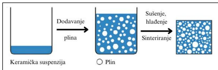
Slika 4. Shematski prikaz postupka izravnog pjenjenja za izradu porozne keramike [2].
