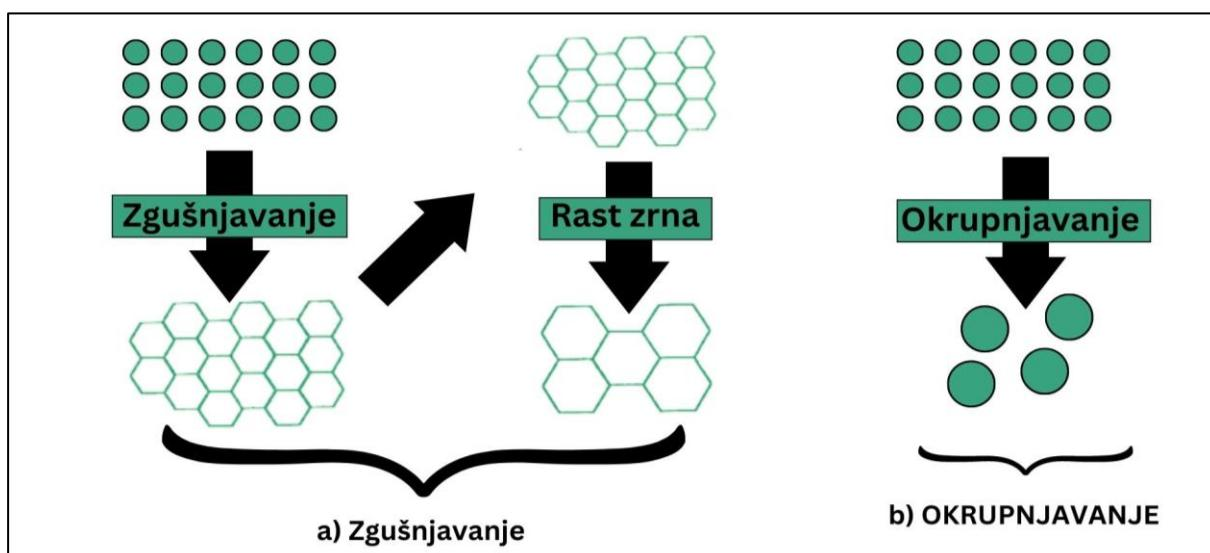
Slika 12. Shematski prikaz (a) zgušnjavanja i (b) okrupnjavanja [13].
