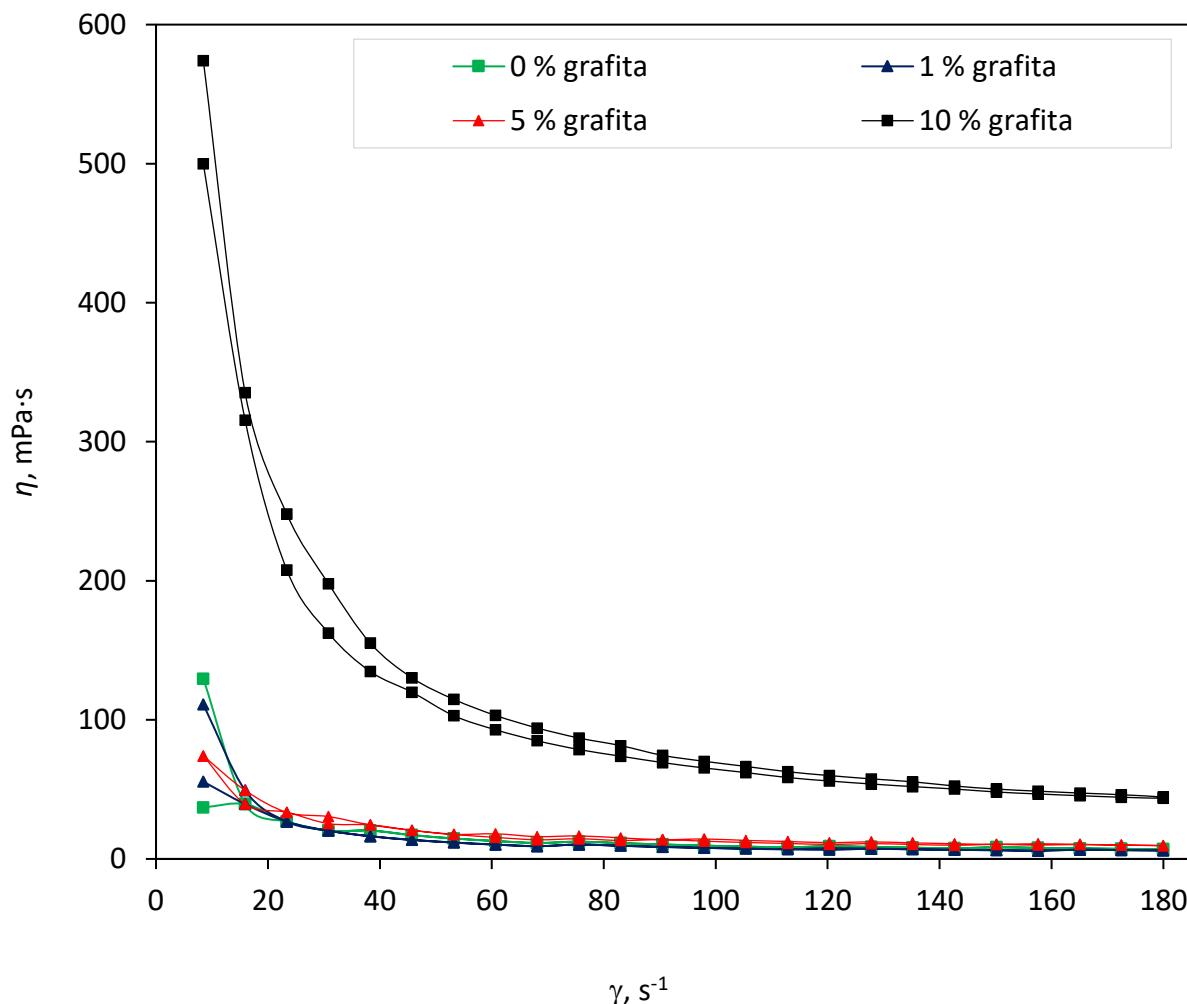
Slika 25. Krivulje tečenja 60 %-tih suspenzija s različitim masenim udjelom otpadnoga grafita (0, 1, 5 i 10 %): ovisnost prividne viskoznosti ( $\eta$ , mPa·s) o brzini smicanja ( $\gamma$ ,  $s^{-1}$ ).
