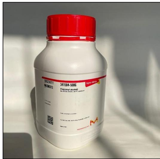
**Slika 18.** Vezivo – polivinil alkohol (PVA).**Tablica 3.** Sastav pripremljenih  $\text{Al}_2\text{O}_3$  suspenzija iskazan u masenim udjelima ( $w, \%$ ).
