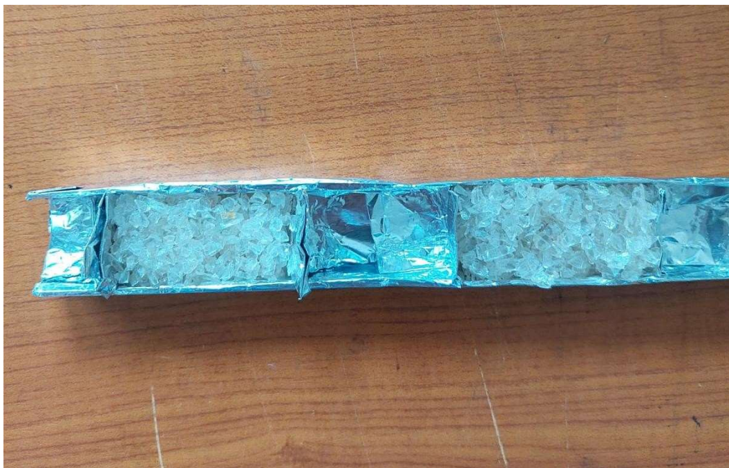
Slika 17. Ispitni uzorci u aluminijskom kalupu
