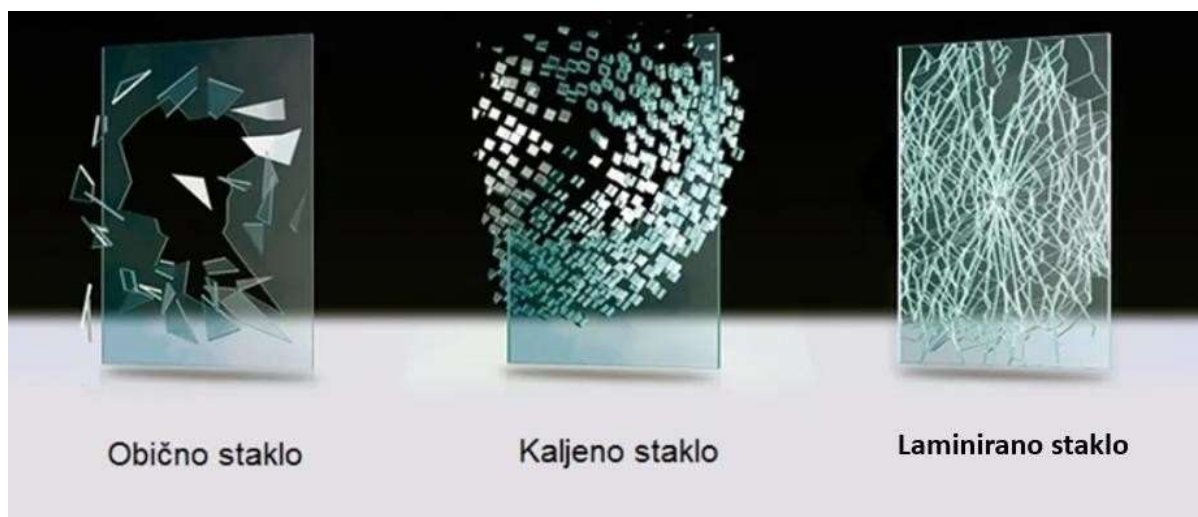
Slika 4. Izgled loma običnog, kaljenog i laminiranog stakla [27]
