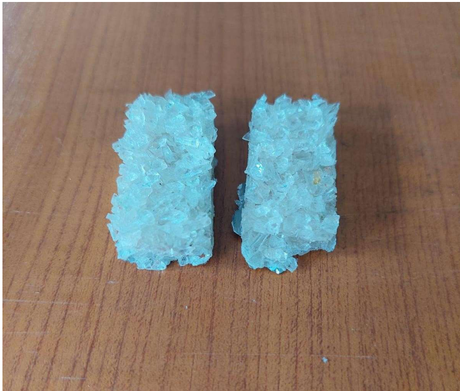
Slika 16. Ispitni uzorci izrađeni od recikliranoga stakla
