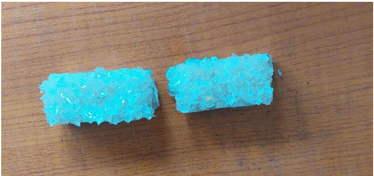
Slika 15. Ispitni uzorci izrađeni od recikliranoga stakla
