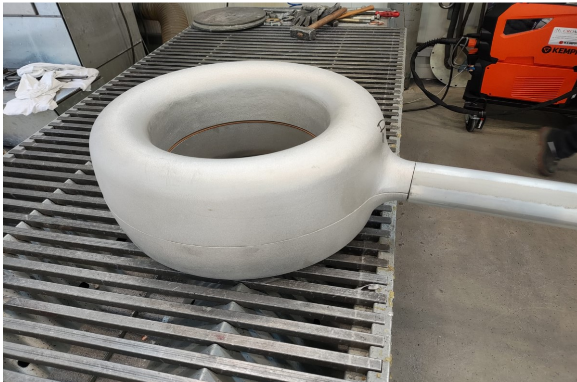
Slika 3.5 Toroidalna jezgra spremna za proces zavarivanja
