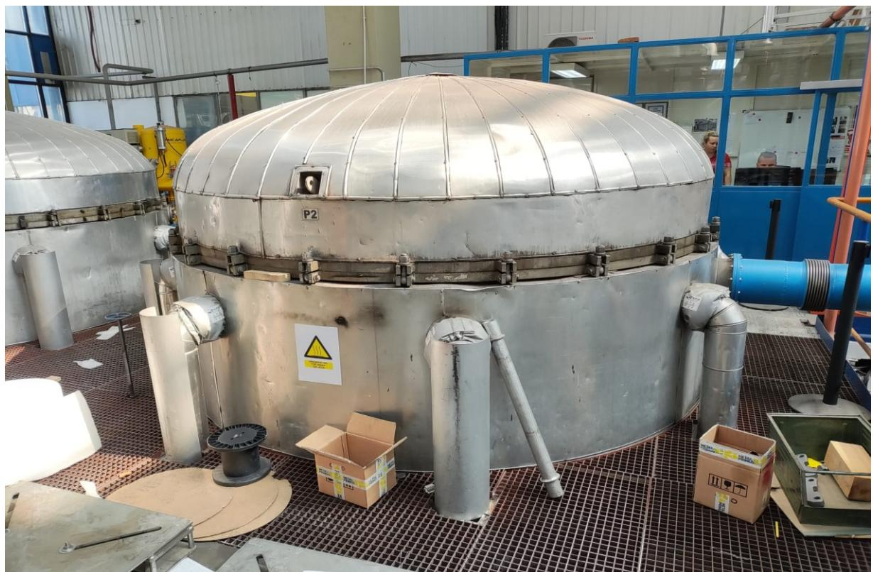
Slika 3.9 Peć za sušenje transformatora
