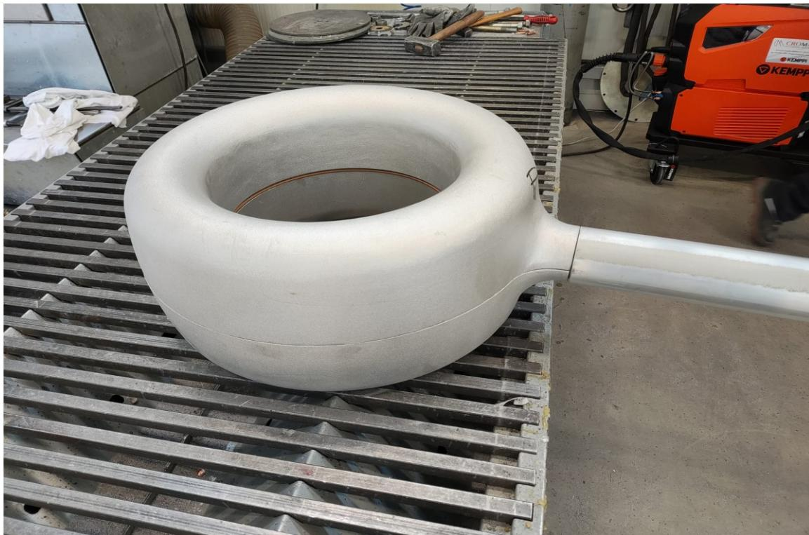
Slika 3.5 Toroidalna jezgra spremna za proces zavarivanja
