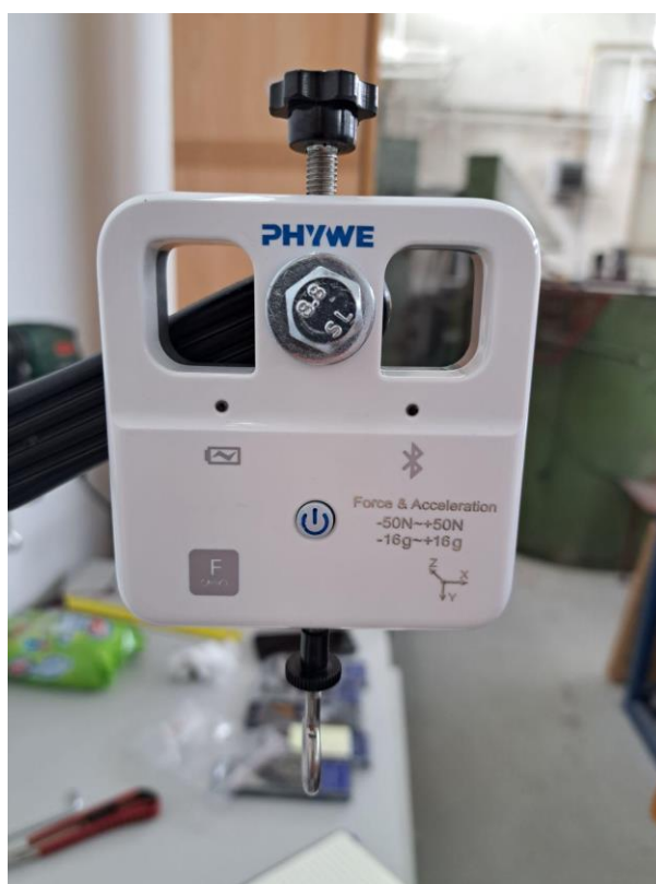
Slika 29. Uređaj za mjerenje posmaka i sila kod bušenja
