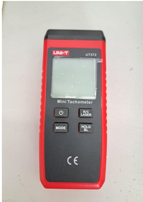
Slika 30. Tahometar korišten za mjerenje brzine okretaja kod bušenja
