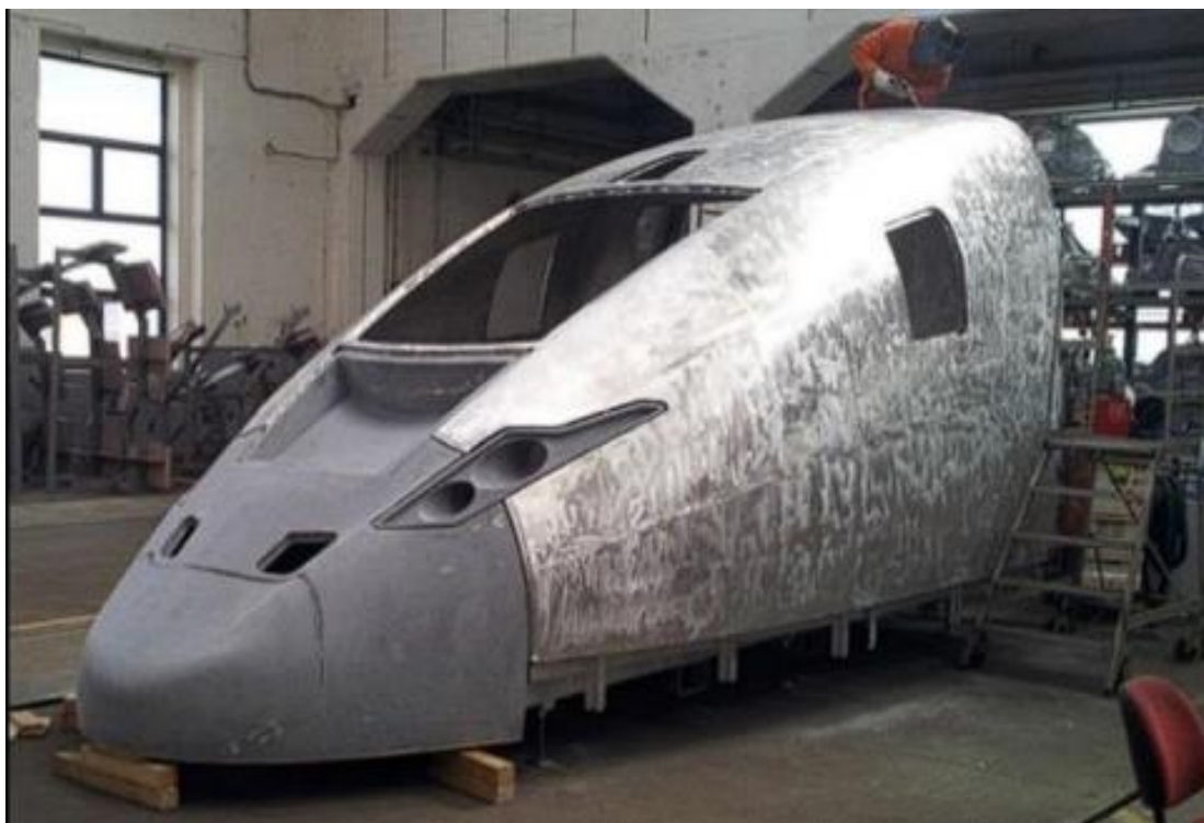
Slika 7. Trup vlaka ojačan aluminijevom pjenom [6]
