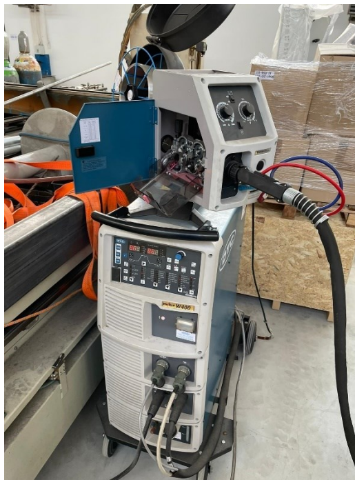
Slika 31 Izvor struje OTC Welbee W400 dual
