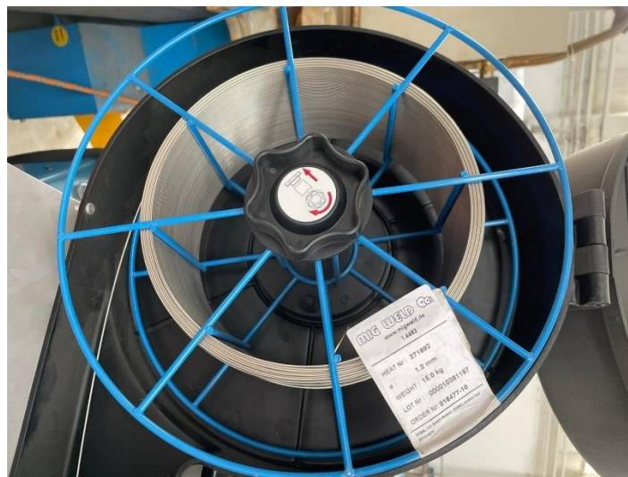
Slika 29 MIG WELD žica promjera 1,2mm
