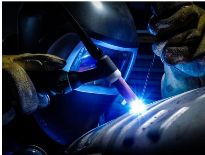
Slika 25 Zavarivanje s M1 mješavinom zaštitnog plina [38]
