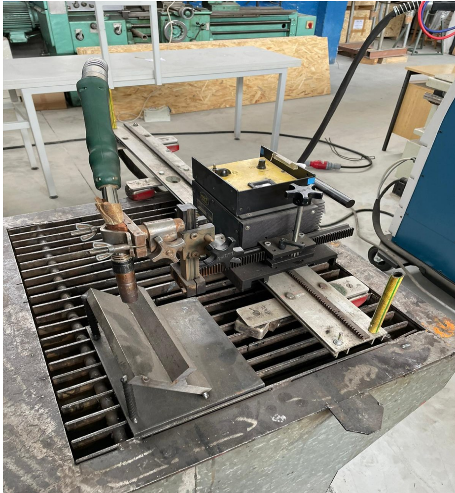
Slika 34 BUG-O automatizirani sustav za zavarivanje
