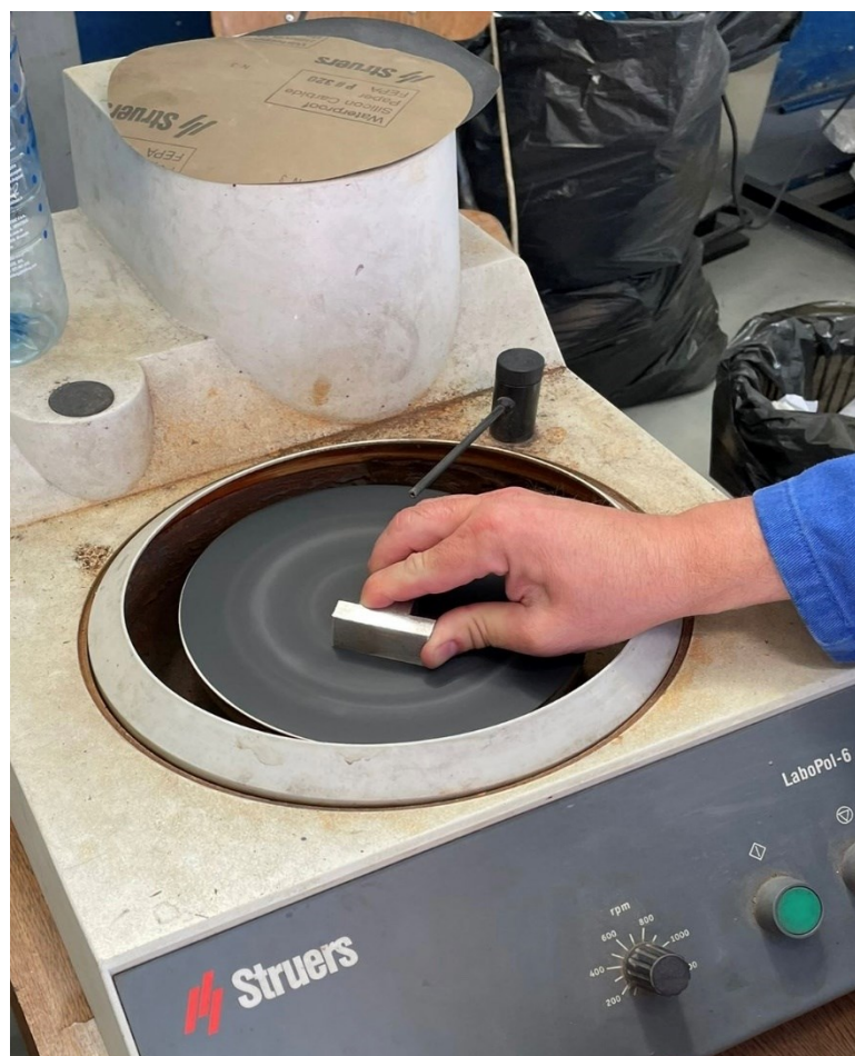
Slika 42 Poliranje ispitnih uzoraka na uređaju Struers
