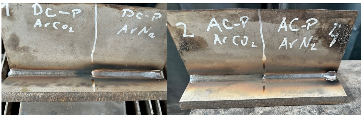
Slika 39 Prikaz ispitnih uzoraka prije čišćenja površine zavara
