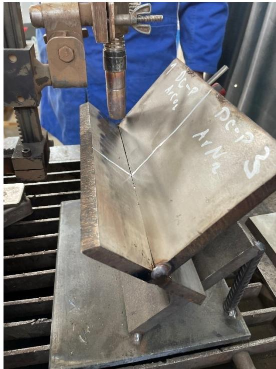
**Slika 28      Priprema ispitnih uzoraka za zavarivanje**
