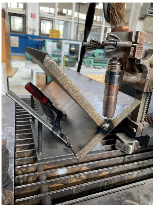
Slika 36 Priprema za zavarivanje na BUG-O sustavu
