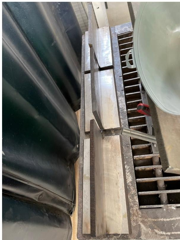
**Slika 35** Pripojeni, očišćeni i odmašćeni ispitni uzorci
