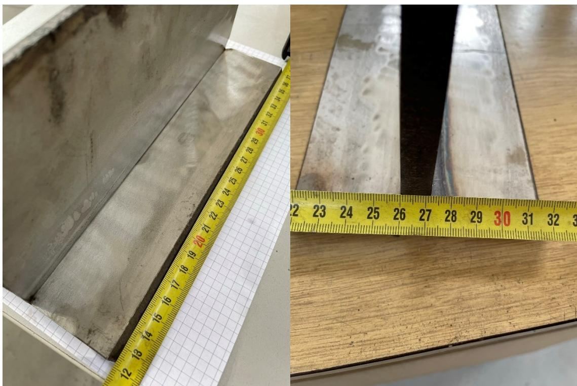
Slika 27 Ispitni uzorak - osnovni materijal X2 CrNiMoN 22-5-3
