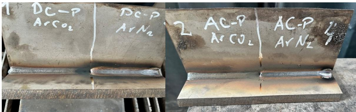
**Slika 39 Prikaz ispitnih uzoraka prije čišćenja površine zavara**
