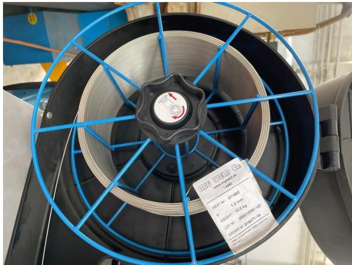
**Slika 29 MIG WELD žica promjera 1,2mm**
