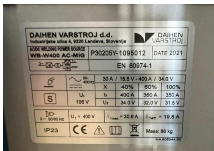
Slika 32      Identifikacijska pločica uređaja OTC Welbee W400
