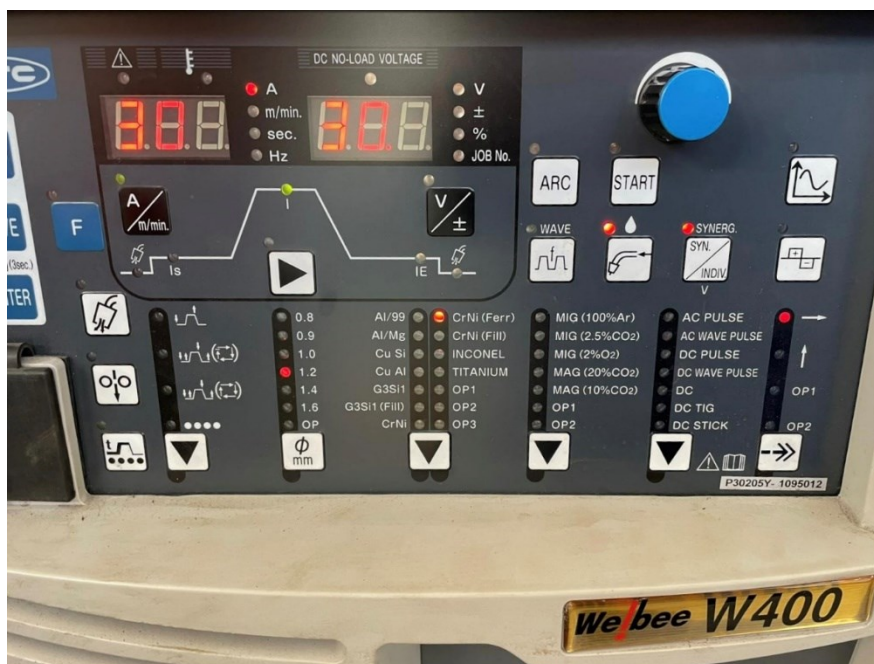
Slika 37 Prikaz postavki programa na izvoru struje
