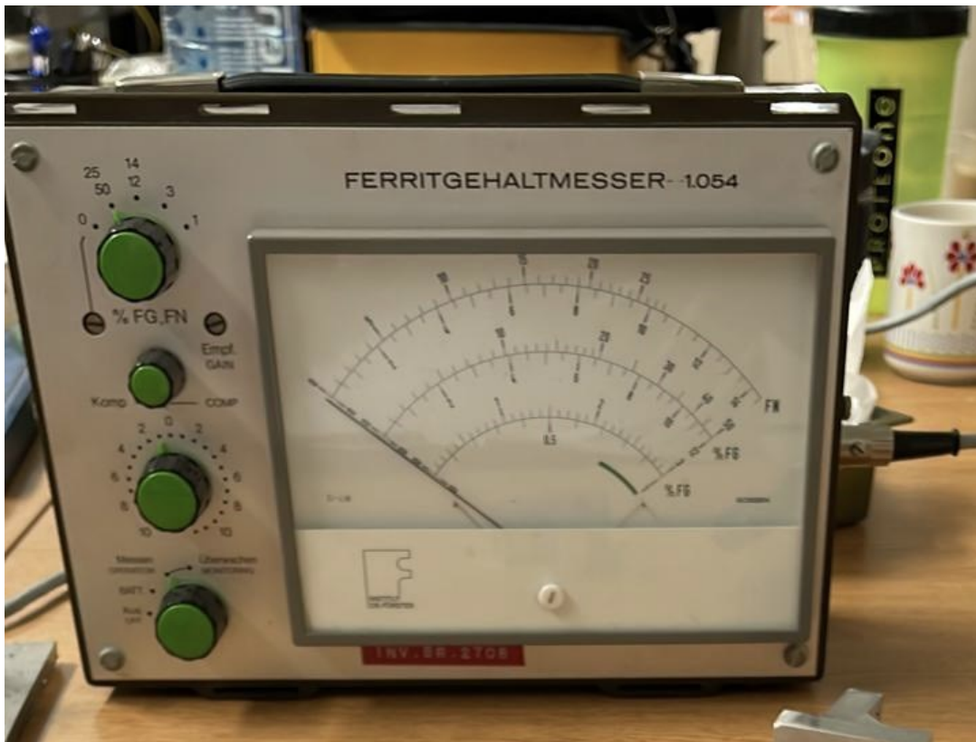
Slika 51 Uređaj za mjerenje udjela ferita – Ferritgehaltmesser
