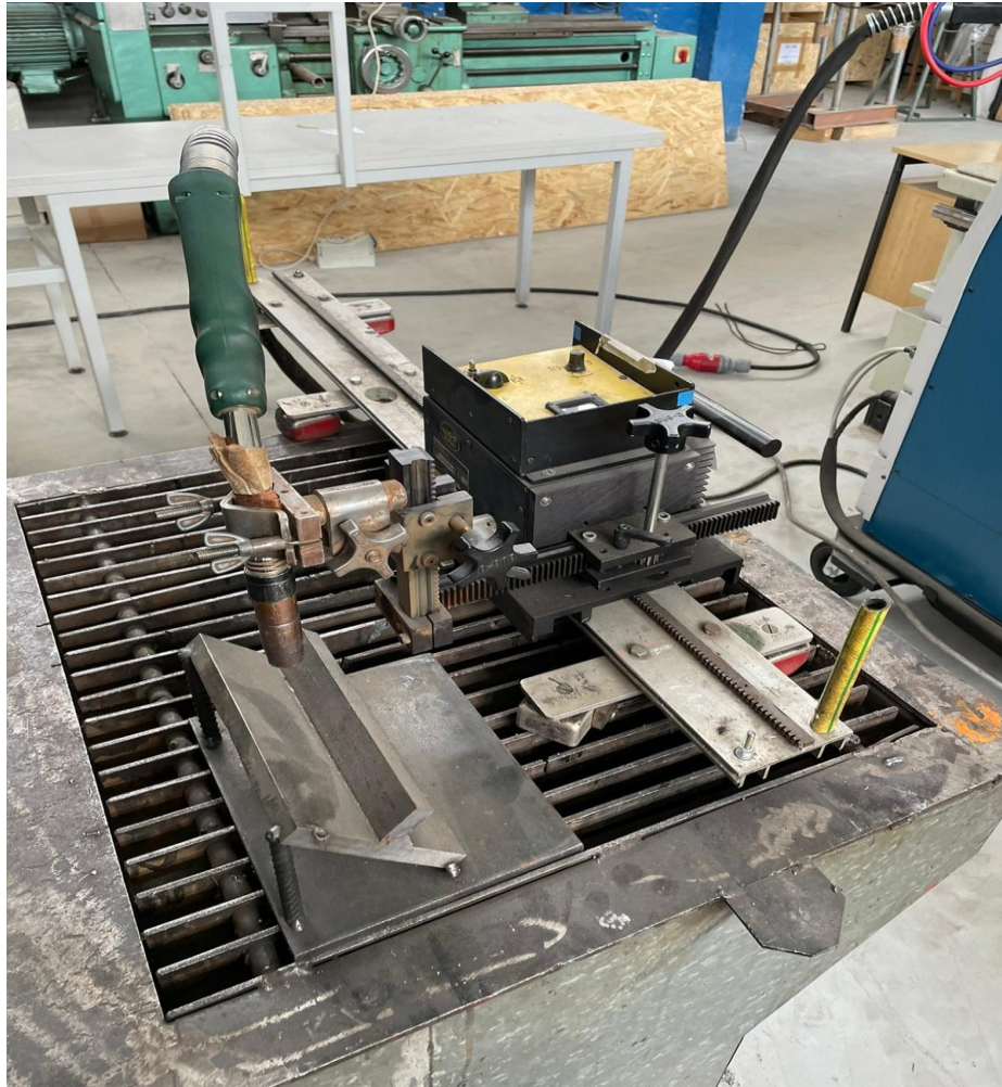
Slika 34 BUG-O automatizirani sustav za zavarivanje
