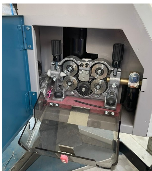
Slika 30 Sustav za dobavu žice pri zavarivanju
