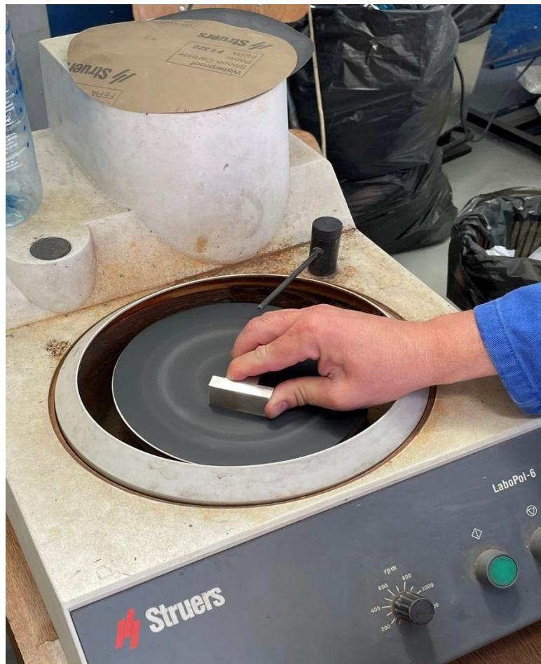
Slika 42 Poliranje ispitnih uzoraka na uređaju Struers
