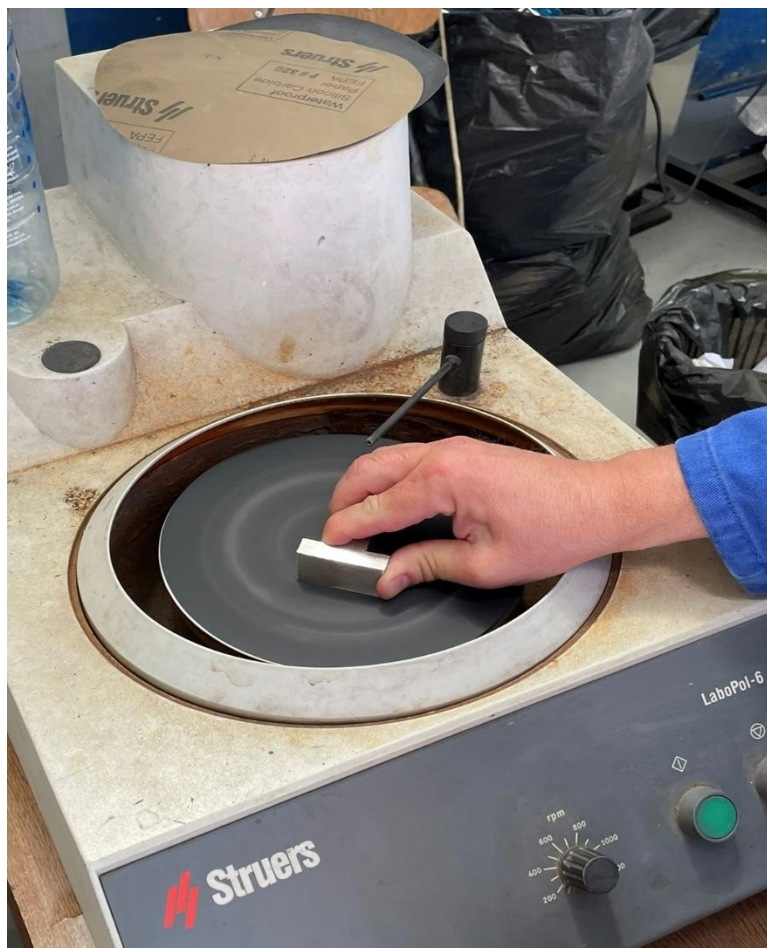
Slika 42 Poliranje ispitnih uzoraka na uređaju Struers
