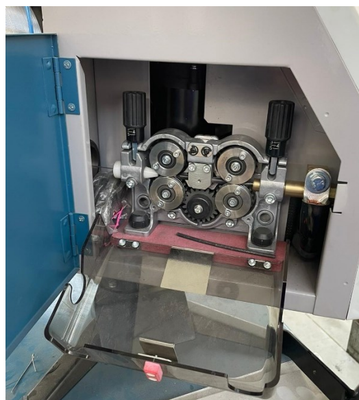
Slika 30 Sustav za dobavu žice pri zavarivanju
