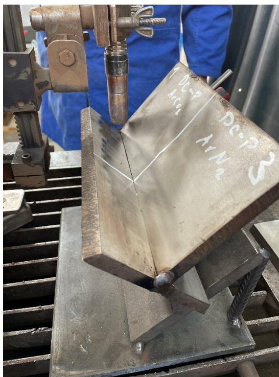
Slika 28 Priprema ispitnih uzoraka za zavarivanje
