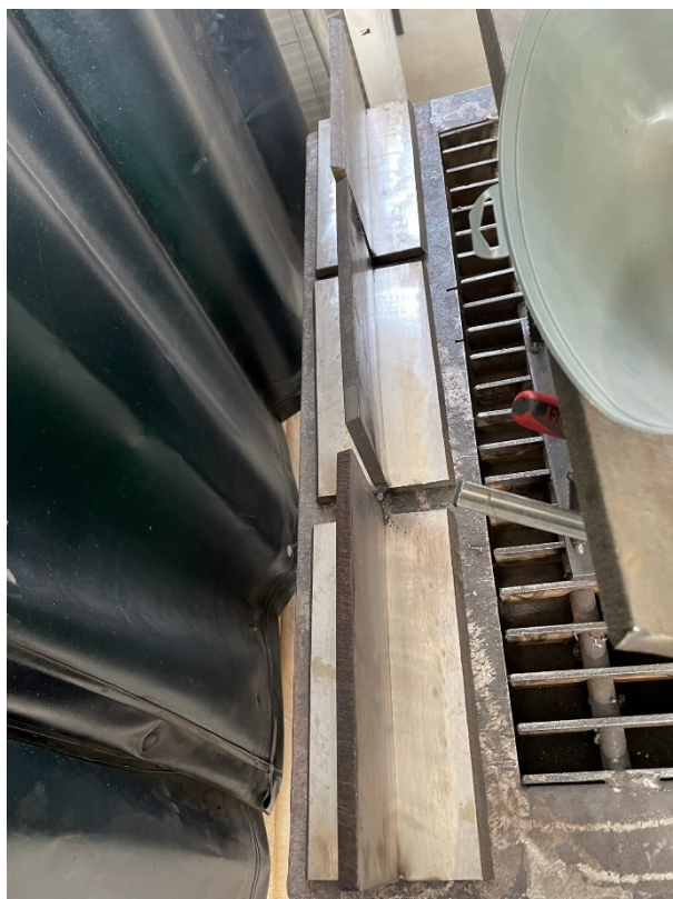
Slika 35 Pripojeni, očišćeni i odmašćeni ispitni uzorci
