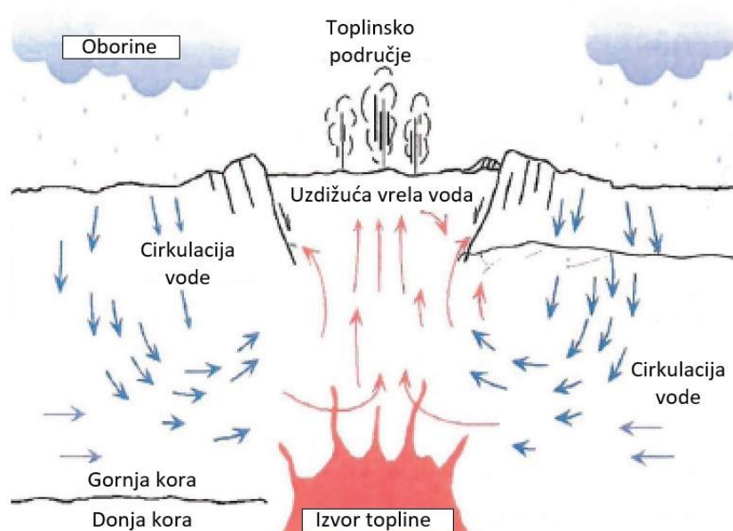
Slika 3. Geotermalni sustav s većinskim udjelom kapljevine [7]
