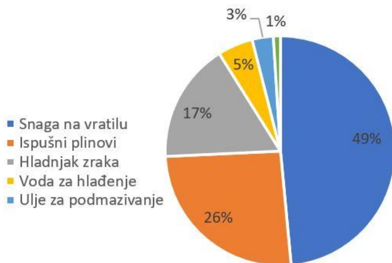
Slika 2 Distribucija energije tipičnog broskog porivnog motora [3]
