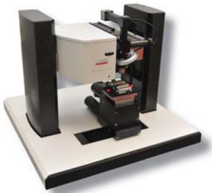
Slika 54: Uređaj za ispitivanje adhezije prevlake na substrat brazdanjem tvrtke CSM, model Micro Scratch Tester [22]
