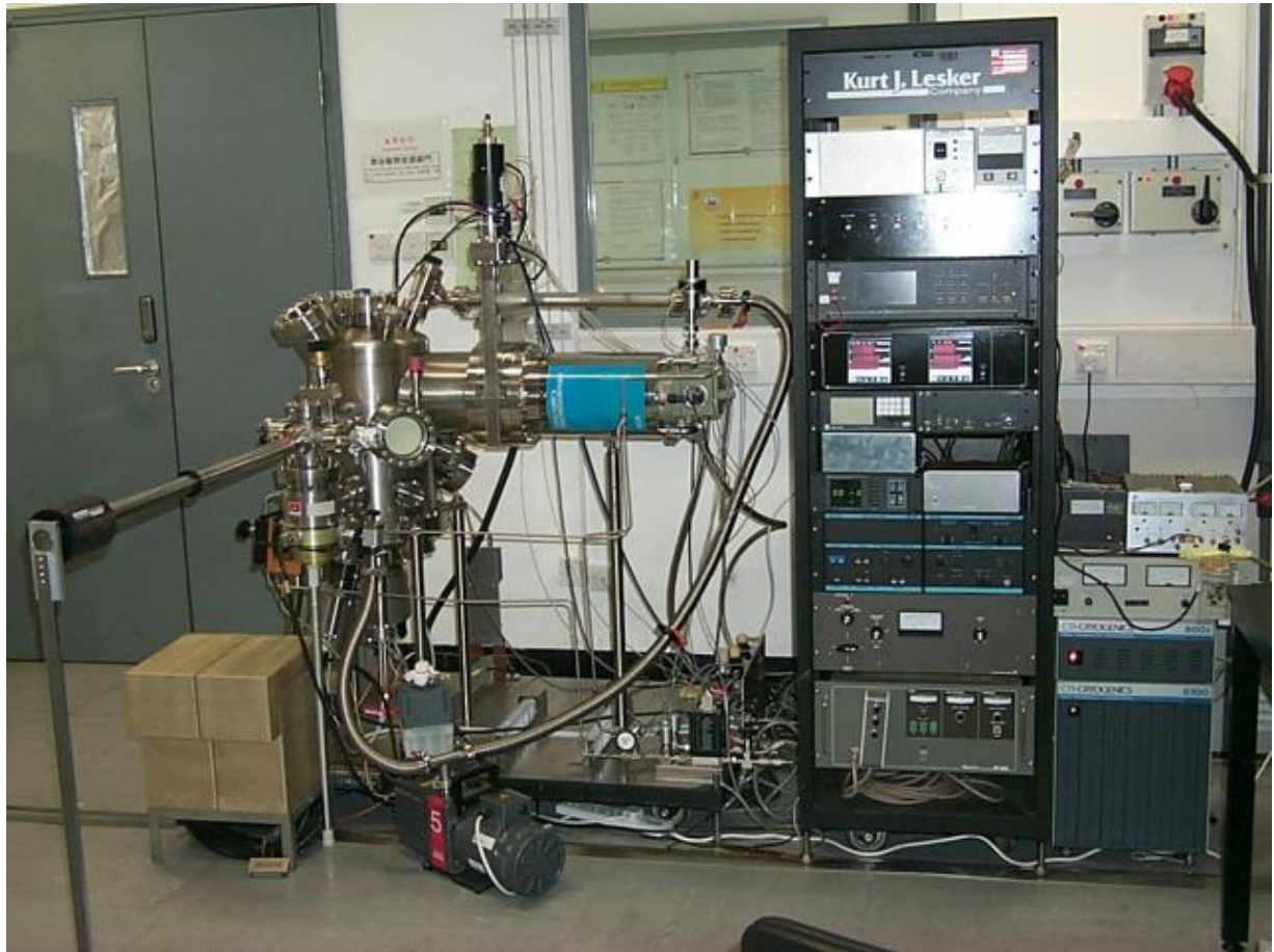
Slika 26: Sustav za PVD postupak magnetskim raspršivanjem materijala prevlake tvrtke Kurt J. Lesker [6]
