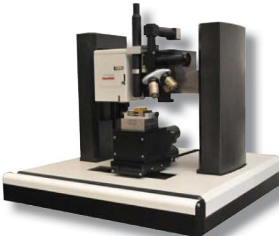
Slika 49: Mikrotvrdomje tvrtke „CSM Instruments”, model Micro Intendation Tester [22]
