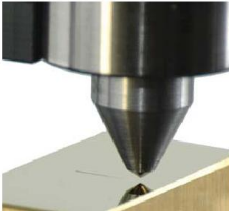
Slika 53: Glava modernog uređaja sa penetratorom za ispitivanje adhezije prevlake na supstrat brazdanjem [22]
