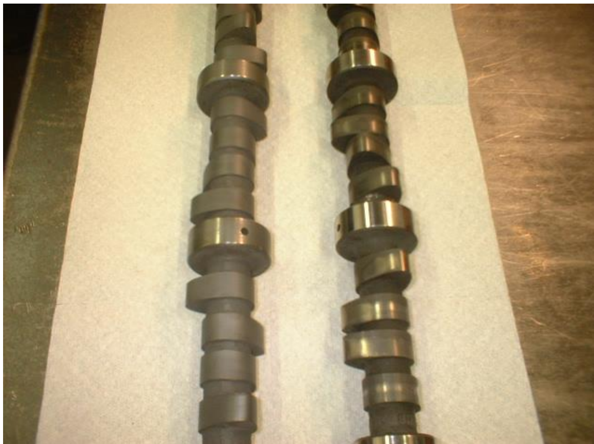
Slika 66: Bregasta osovina i-Vtec motora tvrtke Honda sa bregovima prevučeni prevlakom MoST [5]
