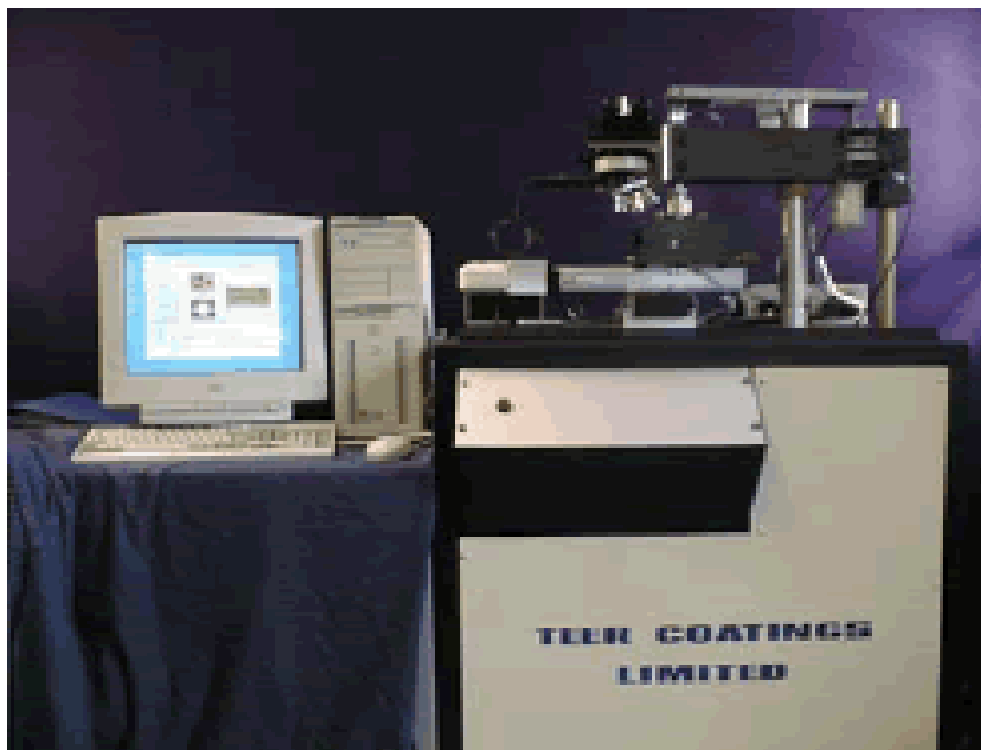
Slika 51: Sustav za ispitivanje adhezije prevlake na substrat brazdanjem [8]
