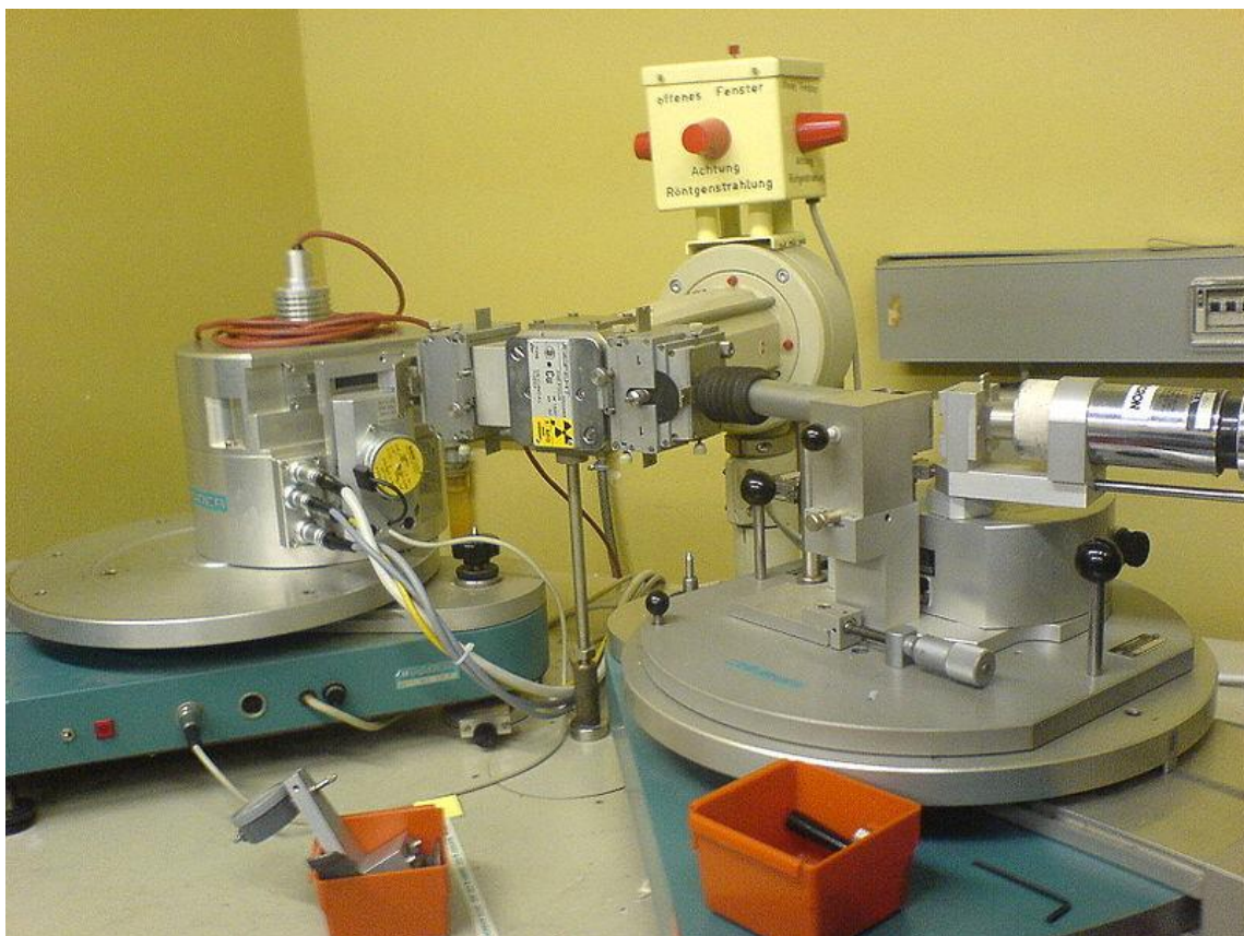
Slika 39: Uređaj za rendgensku strukturnu analizu - difraktometar [5]
