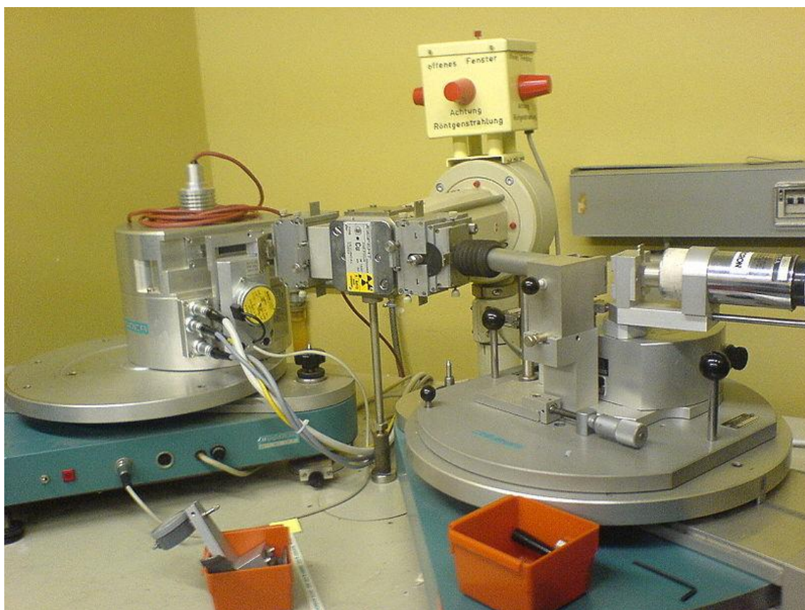
Slika 39: Uređaj za rendgensku strukturnu analizu - difraktometar [5]
