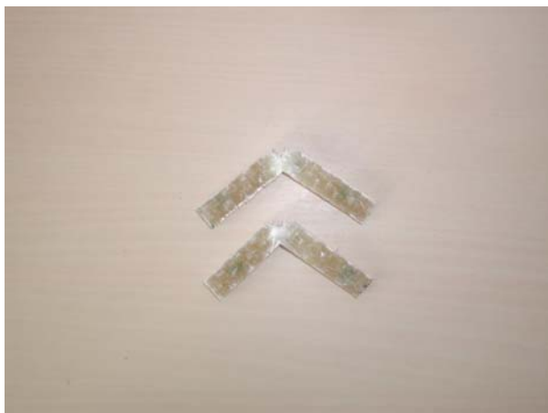
Slika 24. Epruvete sa zarezom koje su otvrdnjavale pri sobnoj temperaturi, potpuni lom
