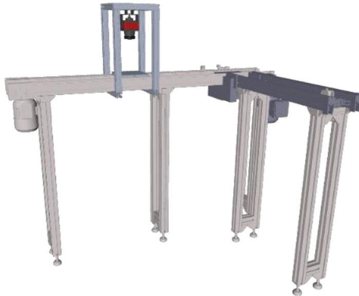
Slika 48. Prikaz pokretne linije sa sustavom za strojni vid opisanom u radu
