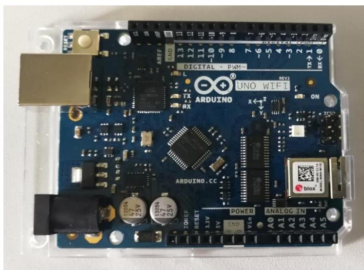
**Slika 44. Upravljačka jedinica – Arduino Uno Wifi Rev 2**
