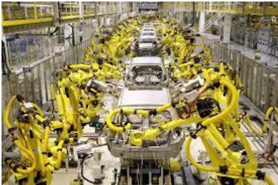
Slika 2. Pokretna automatizirana traka u automobilskoj industriji [1]
