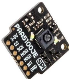
Slika 23. Optički senzor pomaka PAA5100JE [23]
