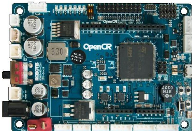
Slika 12. OpenCR razvojna pločica, preuzeto s [12]
