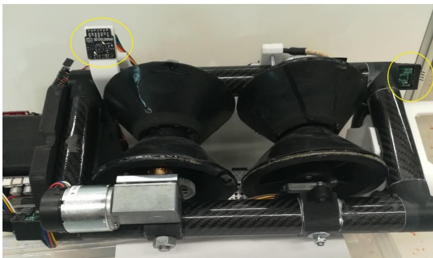
Slika 50. Položaj optičkog senzora pomaka (lijevo) i ToF senzora udaljenosti (desno), na robotu okrenutom naopačke
