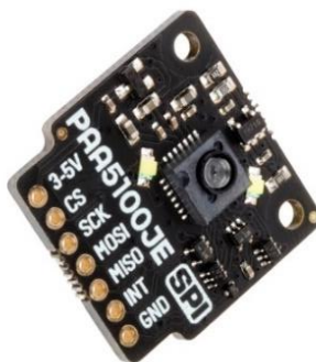
Slika 23. Optički senzor pomaka PAA5100JE [23]
