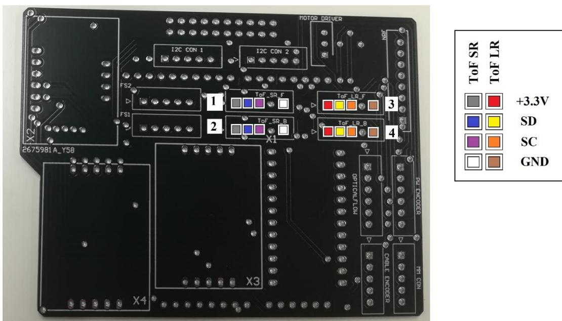
Slika 27. Lokacija konektora na OpenCR adapterskoj pločici
