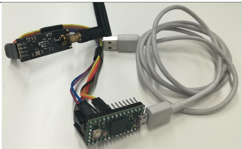
Slika 19. Teensy 4.0 razvojna pločica (sredina), USB konektor za računalu i nRF24L01 radio modul (gore lijevo)
