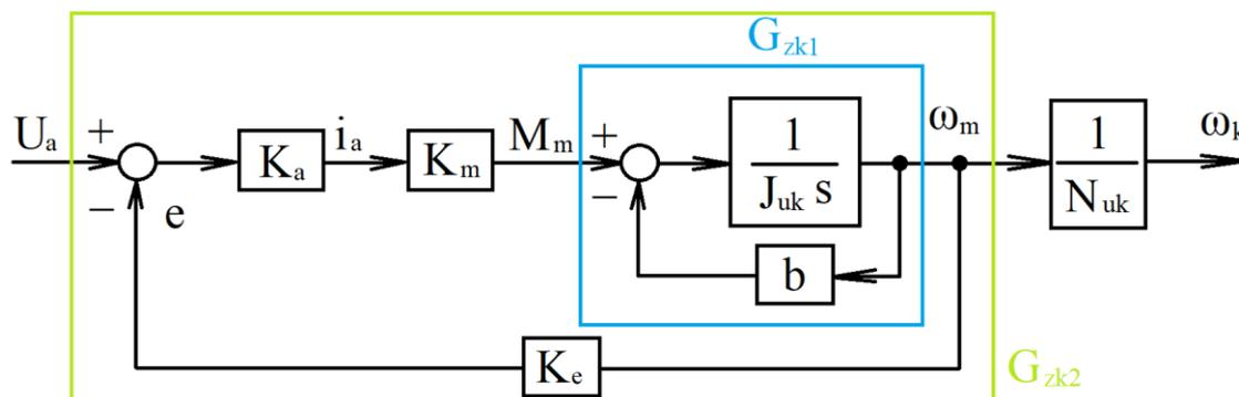
Slika 33. Pojednostavljeni dinamički model elektromotora i pogonskog kotača
