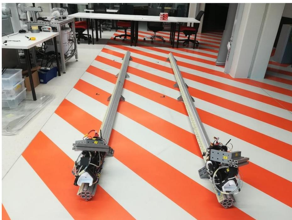
Slika 41. Vodilice ispitnog postava, pogled u smjeru gibanja robota
