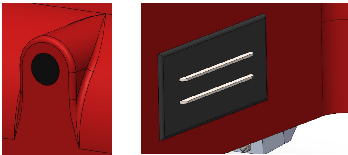
Slika 33. Detalji kamere i kontakta za punjenje
