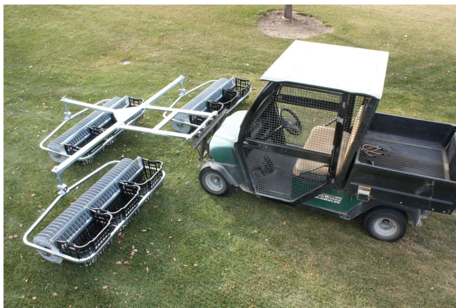
Slika 4. Priključak za skupljanje loptica za golf vozilo
