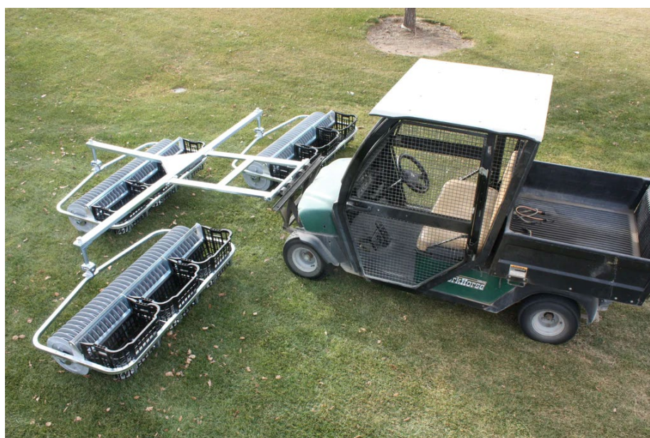
Slika 4. Priključak za skupljanje loptica za golf vozilo
