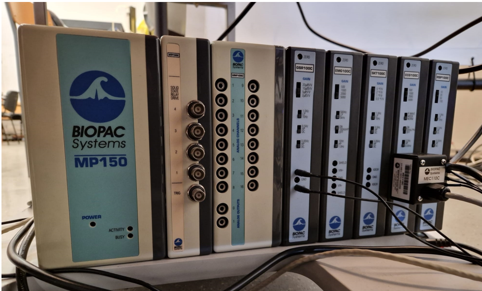
Slika 4.2: Uređaj za prikupljanje fizioloških podataka Biopac MP150
