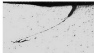
Pukotine na vanjskoj površini zbog nečistoća u čeliku
