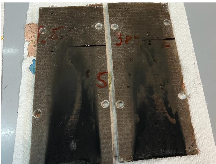
Slika 38. Rezultati ispitivanja ispitnih tijela (kompozit 5) nakon gorenja
