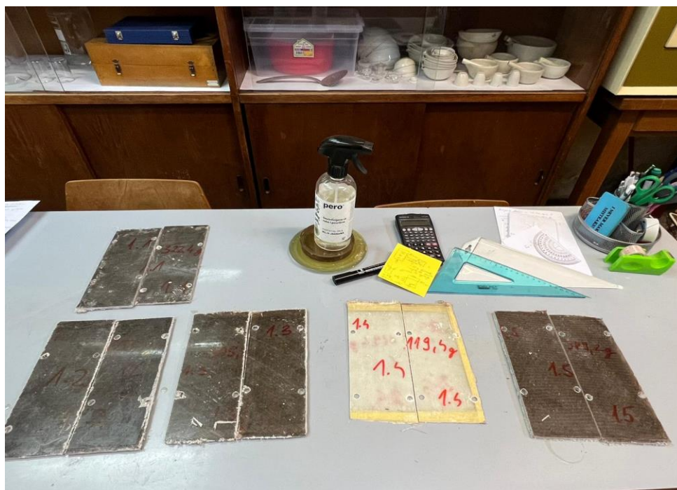
Slika 26. Pripremljena ispitna tijela za ispitivanje gorivosti kompozitnih materijala
