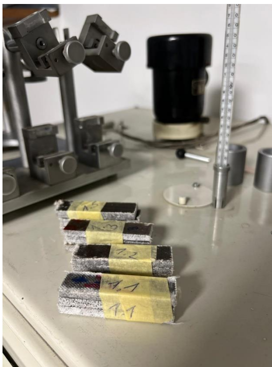
Slika 31. Uzorci pripremljeni za Martens postupak ispitivanja
