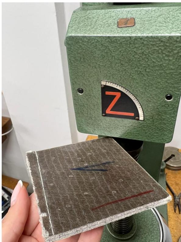
**Slika 39. Rezultati ispitivanja nakon mjerenja tvrdoće**
