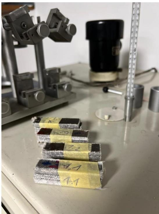
Slika 31. Uzorci pripremljeni za Martens postupak ispitivanja
