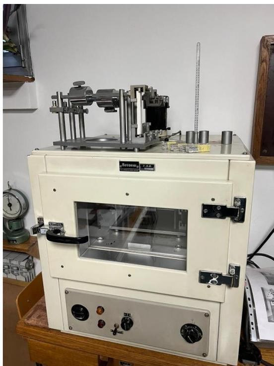
Slika 32. Uređaj za provedbu Martens ispitivanja
