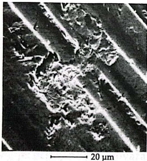
Slika 8. Površina oštećena umorom [4]
