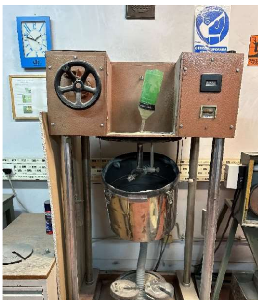
Slika 35. Uređaj za ispitivanje erozijskog trošenja
