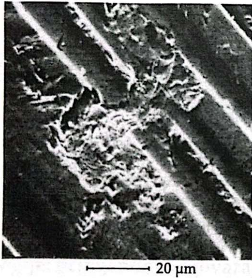
Slika 8. Površina oštećena umorom [4]
