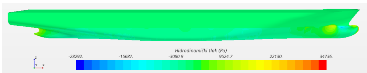
Slika 30. Raspodjela hidrodinamičkog tlaka po trupu broda u naravi u neograničenoj dubini
