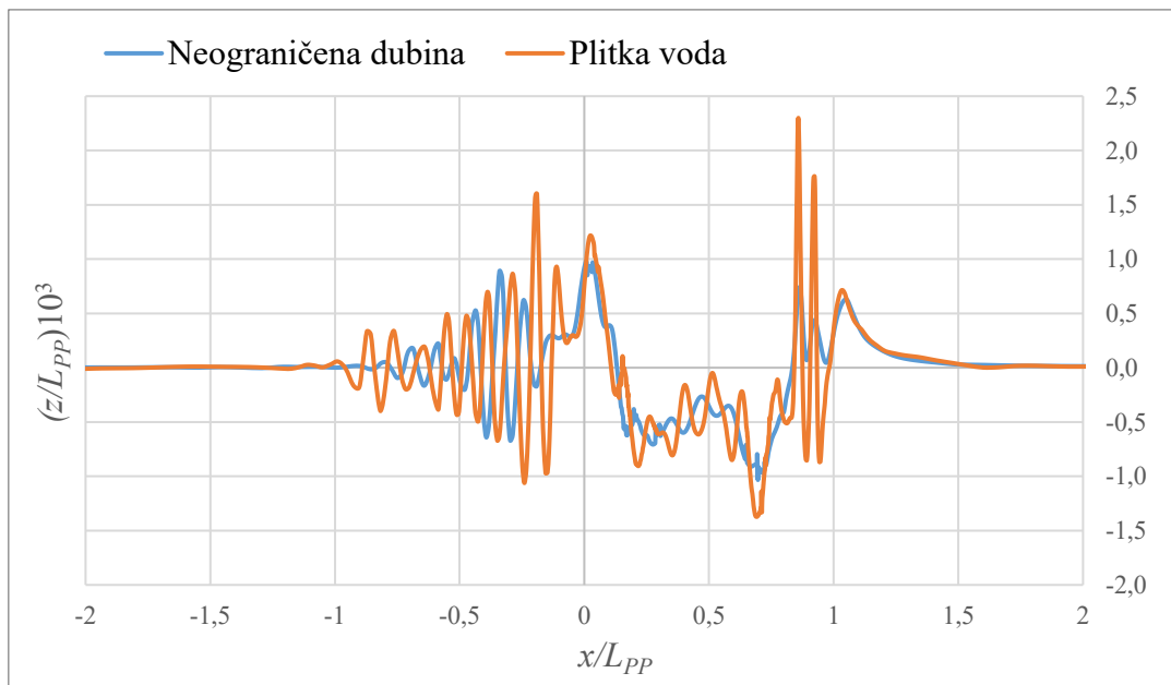
Slika 37. Valne elevacije u neograničenoj i plitkoj vodi na y = 0,29 m duž trupa modela broda
