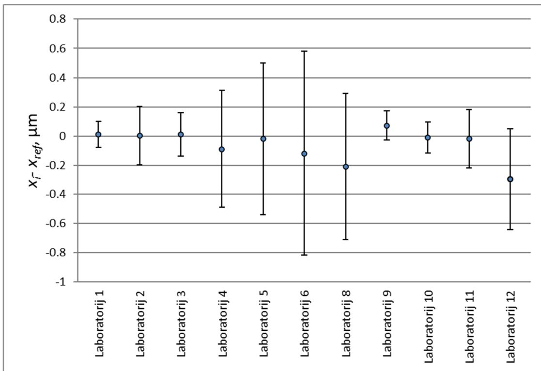
Slika 15. Prikaz odstupanja laboratorijskog rezultata od referentne vrijednosti u EURAMET L-K4 usporedbi nakon izbacivanja Laboratorija 7 iz usporedbe za nazivni promjer  $\emptyset 5 \text{ mm}$  u slučaju referentne vrijednosti određene aritmetičkom srednjom vrijednosti
