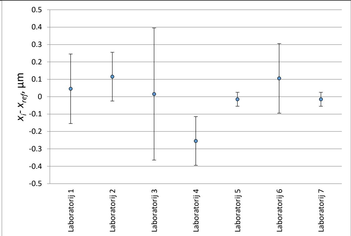
**Slika 20.** Prikaz odstupanja laboratorija od referentne vrijednosti u EURAMET L-S21 usporedbi za kut navoja  $\alpha$  kontrolnog trna M36x1,5 u slučaju referentne vrijednosti određene aritmetičkom srednjom vrijednosti
