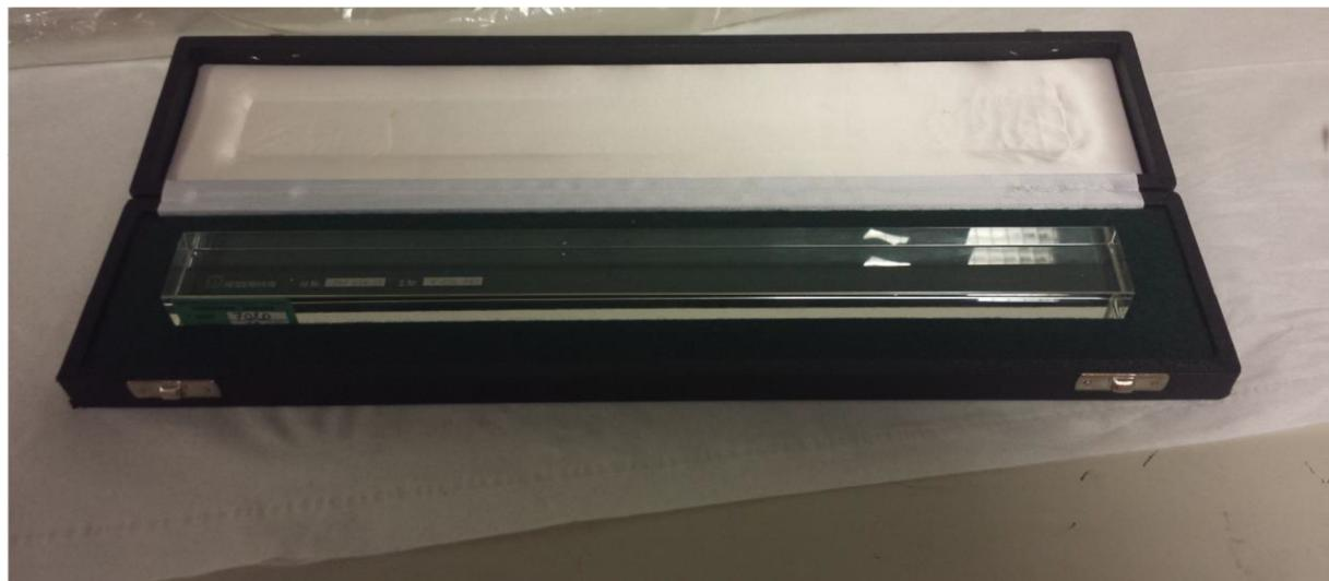
Slika 1. Precizna mjerna skala [21]
