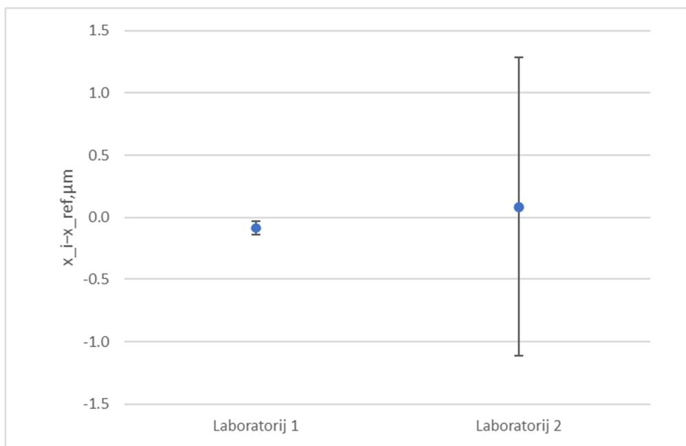
**Slika 5. Prikaz odstupanja laboratorijskog rezultata od referentne vrijednosti u EURAMET L-K7 usporedbi za nazivnu udaljenost od 10 mm u slučaju referentne vrijednosti određene aritmetičkom srednjom vrijednosti**
