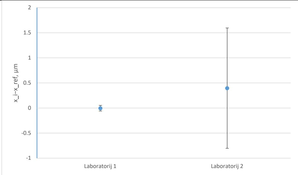
**Slika 7. Prikaz odstupanja laboratorijskih rezultata od referentne vrijednosti u EURAMET L-K7 usporedbi za nazivnu udaljenost od 150 mm u slučaju referentne vrijednosti određene težinskom srednjom vrijednosti**
