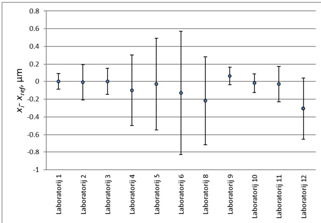
Slika 13. Prikaz odstupanja laboratorijskog rezultata od referentne vrijednosti u EURAMET L-K4 usporedbi nakon izbacivanja Laboratorija 7 iz usporedbe za nazivni promjer  $\emptyset 5$  mm u slučaju referentne vrijednosti određene težinskom srednjom vrijednosti
