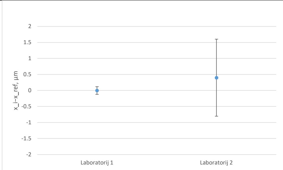
**Slika 6. Prikaz odstupanja laboratorija od referentne vrijednosti u EURAMET L-K7 usporedbi za nazivnu udaljenost od 150 mm u slučaju poznate referente vrijednosti**
