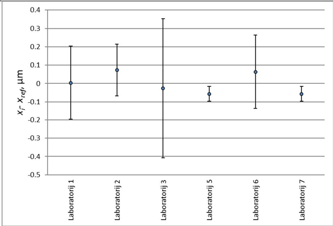
**Slika 21.** Prikaz odstupanja laboratorijskih rezultata od referentne vrijednosti u EURAMET L-S21 usporedbi nakon izbacivanja Laboratorija 4 iz usporedbe za kut navoja  $\alpha$  kontrolnog trna M36x1,5 u slučaju referentne vrijednosti određene aritmetičkom srednjom vrijednosti
