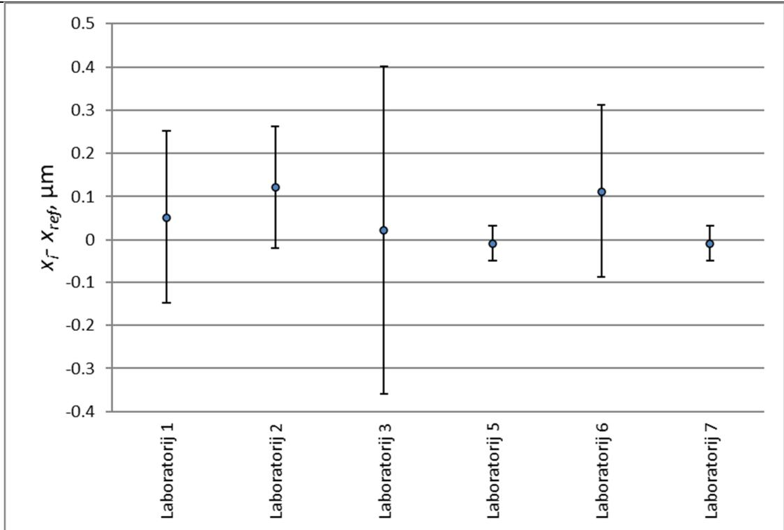
**Slika 19.** Prikaz odstupanja laboratorija od referentne vrijednosti u EURAMET L-S21 usporedbi nakon izbacivanja *Laboratorija 4* iz usporedbe za kut navoja  $\alpha$  kontrolnog trna M36x1,5 u slučaju referentne vrijednosti određene težinskom srednjom vrijednosti
