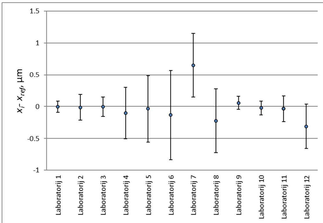
**Slika 12. Prikaz odstupanja laboratorijskog rezultata od referentne vrijednosti u EURAMET L-K4 usporedbi za nazivni promjer  $\emptyset 5$  mm u slučaju referentne vrijednosti određene težinskom srednjom vrijednosti**
