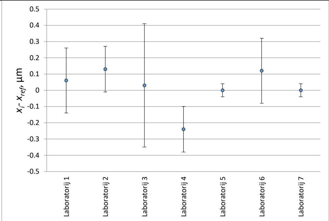
**Slika 18. Prikaz odstupanja laboratorijskih rezultata od referentne vrijednosti u EURAMET L-S21 usporedbi za kut navoja  $\alpha$  kontrolnog trna M36x1,5 u slučaju referentne vrijednosti određene težinskom srednjom vrijednosti**
