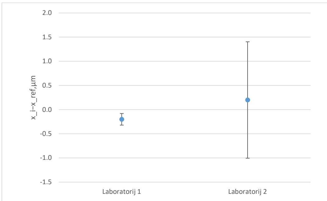
**Slika 8. Prikaz odstupanja laboratorijskog rezultata od referentne vrijednosti u EURAMET L-K7 usporedbi za nazivnu udaljenost od 150 mm u slučaju referentne vrijednosti određene aritmetičkom srednjom vrijednosti**
