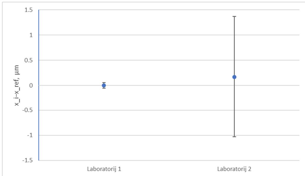
**Slika 4. Prikaz odstupanja laboratorijskog rezultata od referentne vrijednosti u EURAMET L-K7 usporedbi za nazivnu udaljenost od 10 mm u slučaju referentne vrijednosti određene težinskom srednjom vrijednosti**
