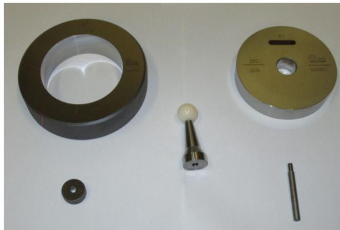
**Slika 10. Kontrolni prstenovi, kontrolni trnovi i mjerna kugla [22]**
