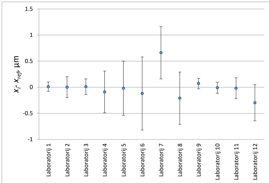
**Slika 14.** Prikaz odstupanja laboratorijskog rezultata od referentne vrijednosti u EURAMET L-K4 usporedbi za nazivni promjer  $\emptyset 5 \text{ mm}$  u slučaju referentne vrijednosti određene aritmetičkom srednjom vrijednosti
