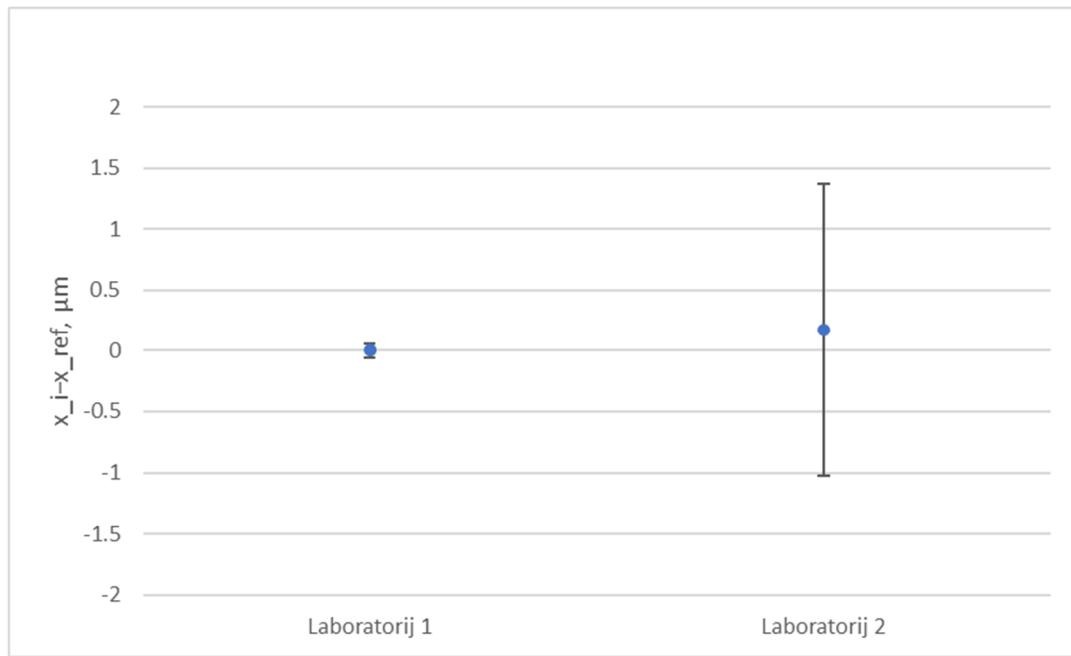
**Slika 3. Prikaz odstupanja laboratorijskog rezultata od referentne vrijednosti u EURAMET L-K7 usporedbi za nazivnu udaljenost od 10 mm u slučaju poznate referentne vrijednosti**
