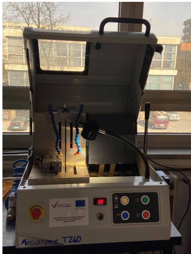
Slika 19. Pila Mecatome T260
