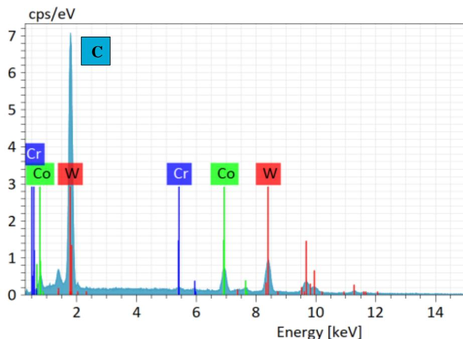
Slika 22. EDS analiza alata tvrdog metala
