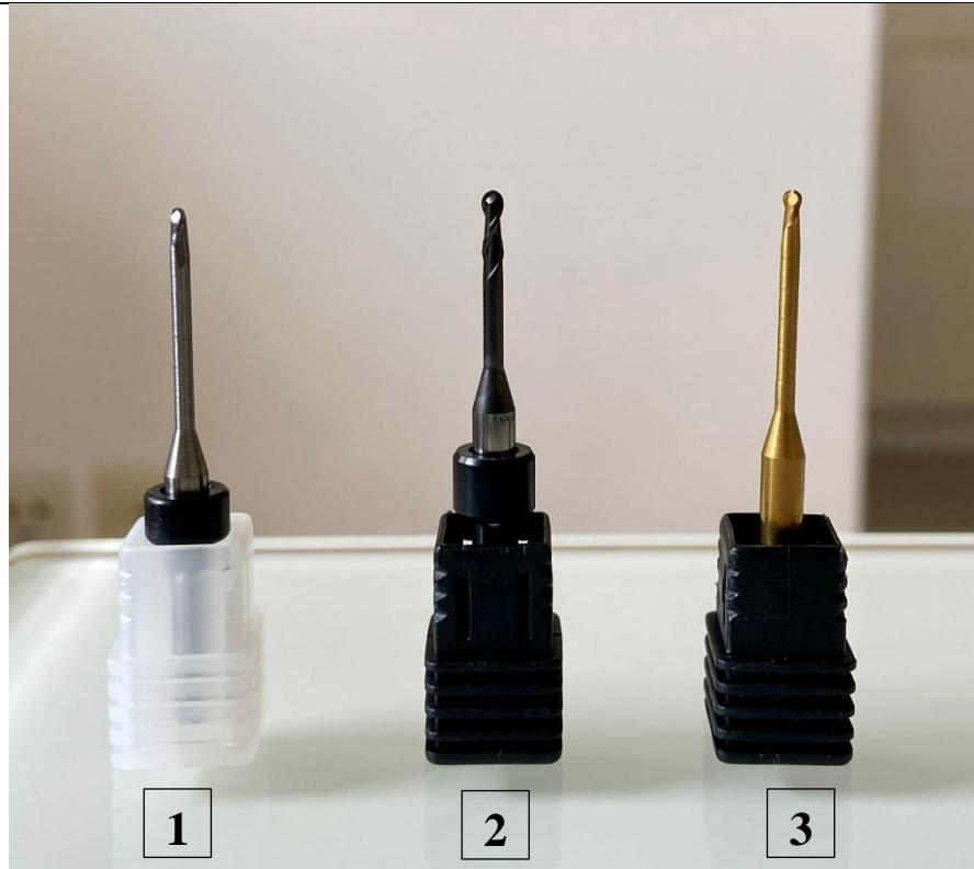
**Slika 13. Rezni alati glodalice na kojima su provedena ispitivanja ( 1- alat od tvrdog metala bez prevlakе na površini, 2- alat s dijamantnom prevlakом, 3- alat s titanij-nitrid prevlakом)**
