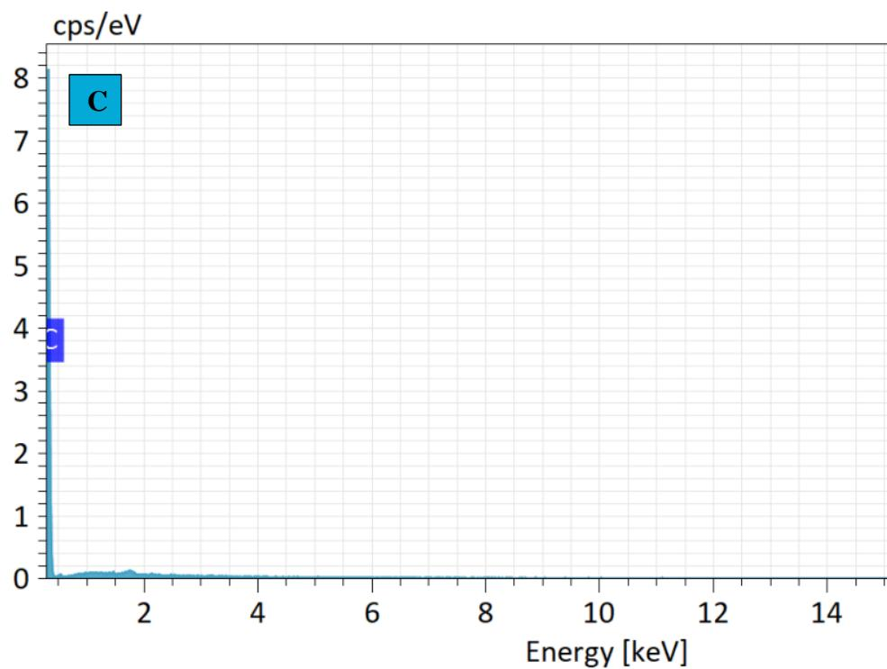
Slika 24. EDS analiza prevlake (lokacija 1) svrdla s dijamantnom prevlakom
