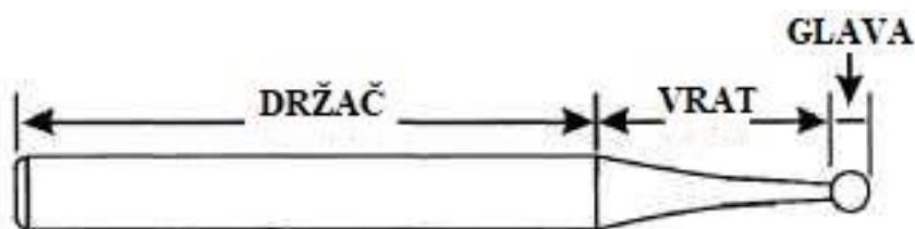
Slika 9. Dijelovi reznog alata za izradu protetskih nadomjestaka [27]
