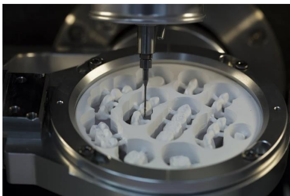
Slika 6. Postupak suhog glodanja [21]
