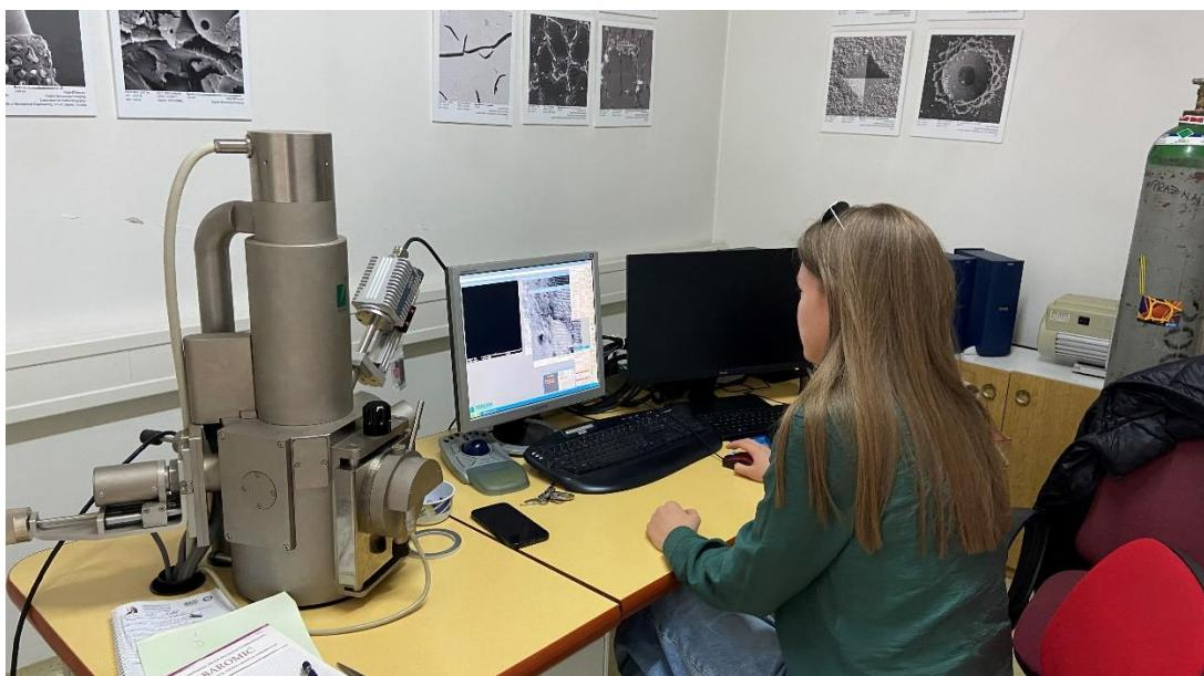
Slika 29. Karakterizacija debljine prevlake na skenirajućem elektronskom mikroskopu
