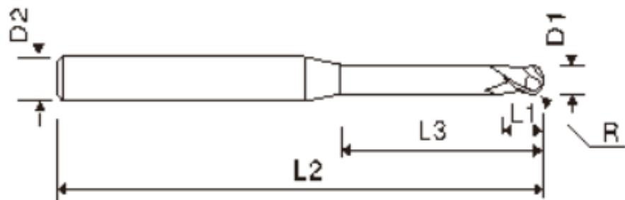
**Slika 14. Tehnički crtež alata za glodanje [35]**
