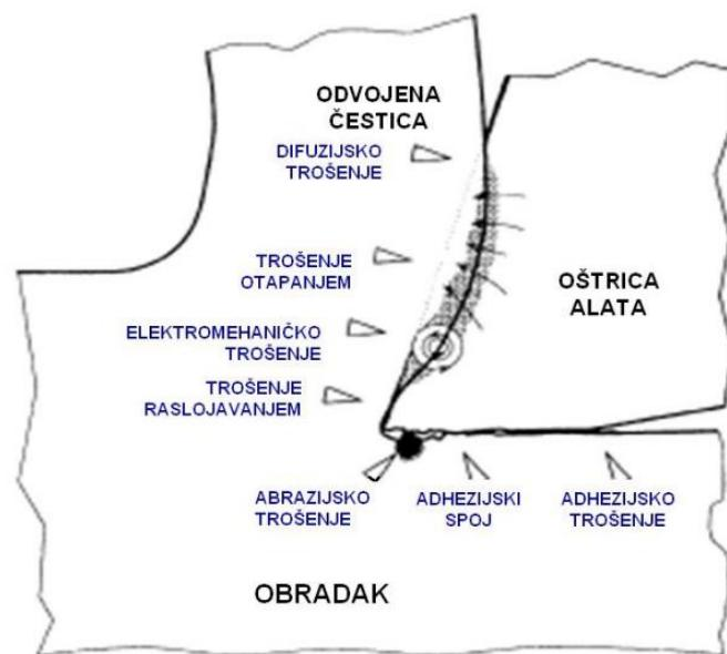
**Slika 12. Mehanizmi trošenja oštice rezognog alata [34]**
