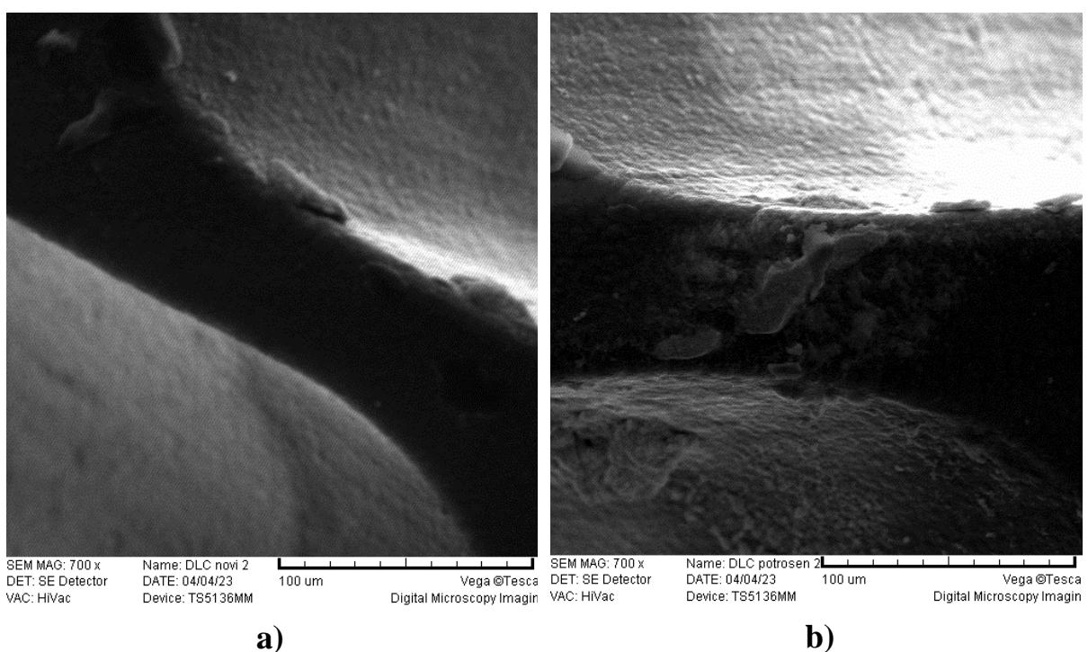
**Slika 36. SEM analiza stanja površine alata s dijamantnom prevlakom pri uvećanju 700 puta u nepotrošenom stanju (a) i potrošenom stanju (b)**
