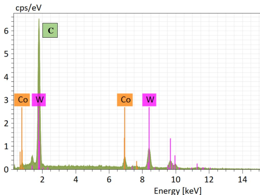
**Slika 28. EDS analiza svrdla s titanij-nitrid prevlakom (lokacija 2)****Tablica 7. Kvantitativni prikaz EDS analize svrdla s titanij-nitrid prevlakom (lokacija 2)**
