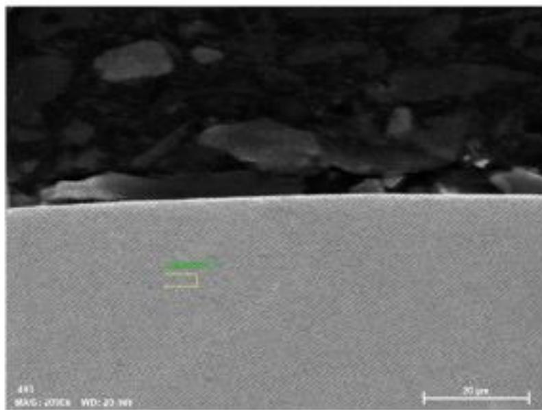
Slika 21. Lokacija EDS analize alata tvrdog metala
