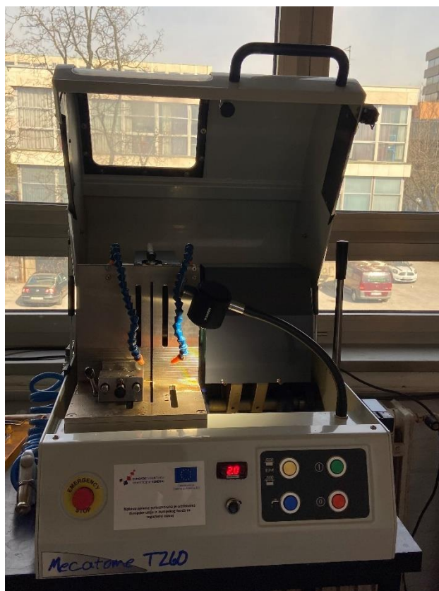
Slika 19. Pila Mecatome T260
