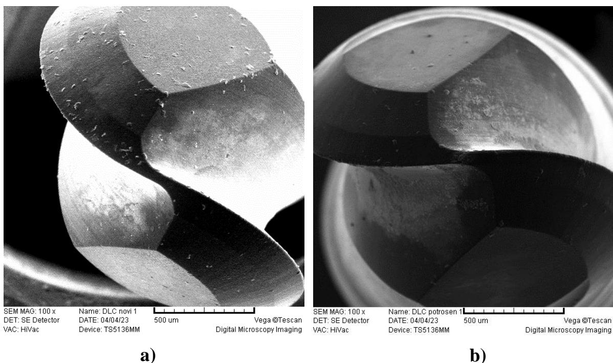
**Slika 35. SEM analiza stanja površine alata s dijamantnom prevlakom pri uvećanju 100 puta u nepotrošenom stanju (a) i potrošenom stanju (b)**
