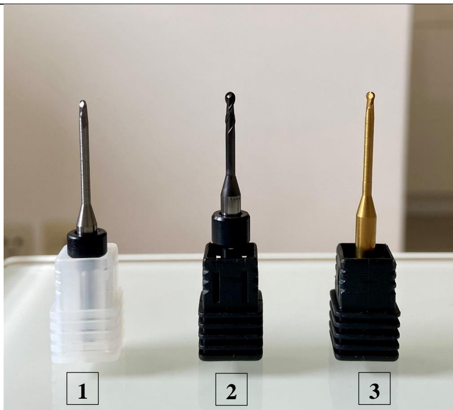
Slika 13. Rezni alati glodalice na kojima su provedena ispitivanja ( 1- alat od tvrdog metala bez prevlake na površini, 2- alat s dijamantnom prevlakom, 3- alat s titanij-nitrid prevlakom)
