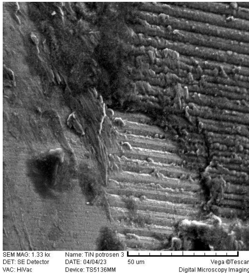
Slika 39. SEM analiza detalja površine alata s titanij-nitrid prevlakom uvećan 13330 puta
