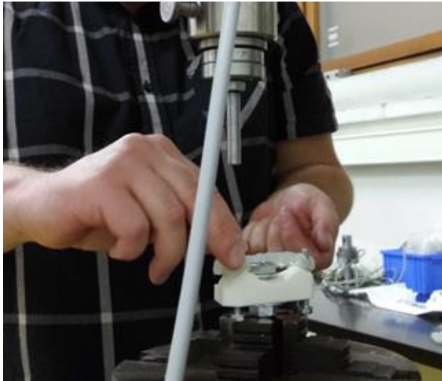
Slika 6.7. Montaža eksperimentalnog postava na radni stol kidalice
