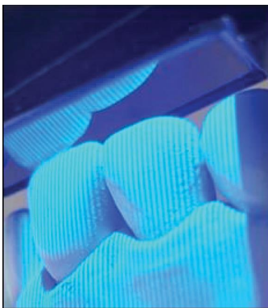
Slika 1.5. Raster pruga kod digitalizacije intraoralnim skenerom [36]
