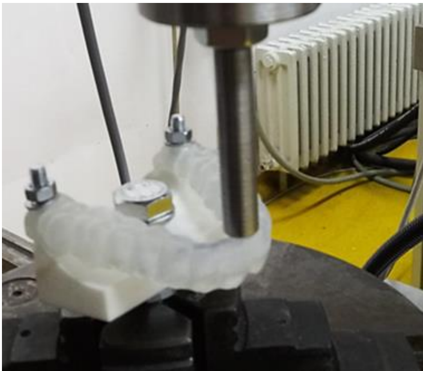
Slika 6.8. Eksperimentalni postav 1 ugrađen na radni stol kidalice
