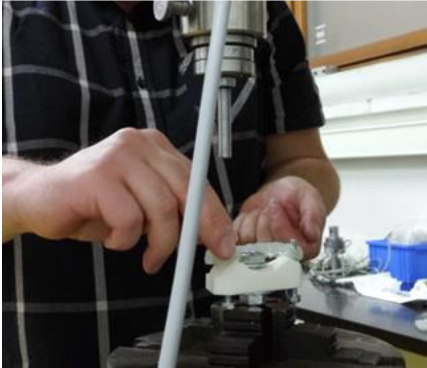
Slika 6.7. Montaža eksperimentalnog postava na radni stol kidalice
