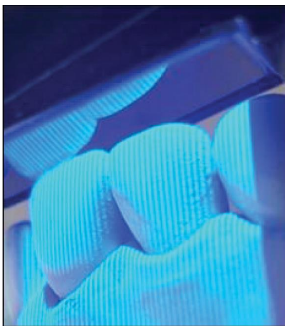
Slika 1.5. Raster pruga kod digitalizacije intraoralnim skenerom [36]
