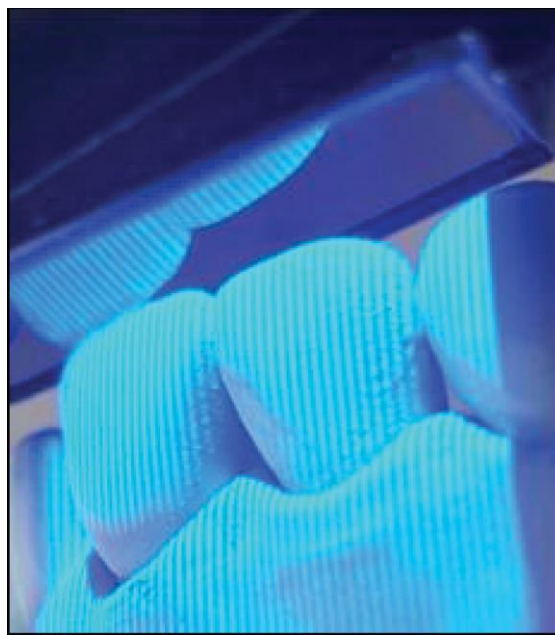
Slika 1.5. Raster pruga kod digitalizacije intraoralnim skenerom [36]
