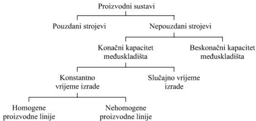
Slika 1.4 Kategorizacija proizvodnih sustava prema pouzdanosti strojeva [41]
