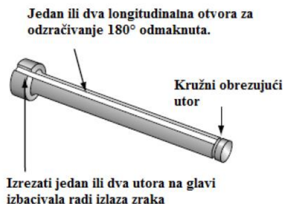
Slika 27. Primjer kanala za odzračivanje na izbacivalu [6]
