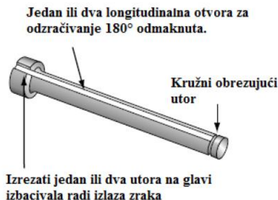
Slika 27. Primjer kanala za odzračivanje na izbacivalu [6]
