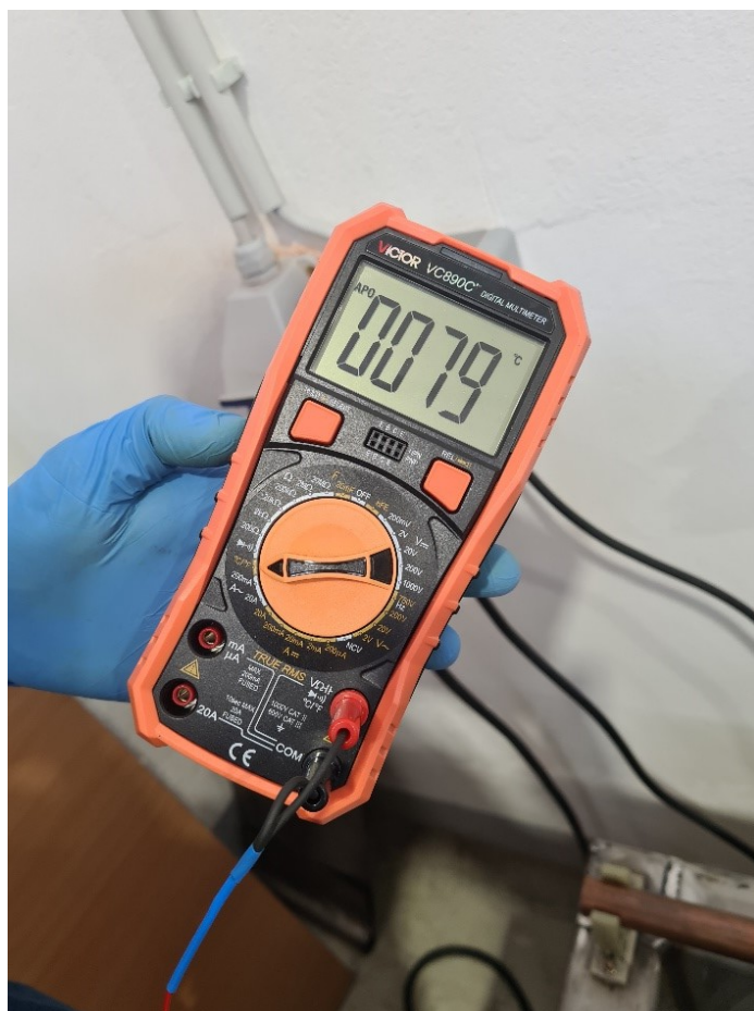
Slika 14. Vrijednost temperature elektrolita izmjerena kontaktnim mjačem temperature
