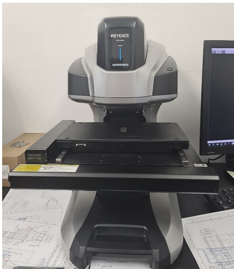
Slika 18. Uređaj za mjerenje hrapavosti površine Keyence VR-6000
