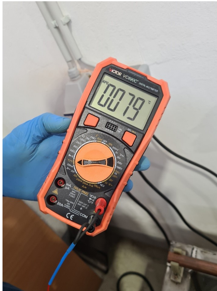
Slika 14. Vrijednost temperature elektrolita izmjerena kontaktnim mjačem temperature
