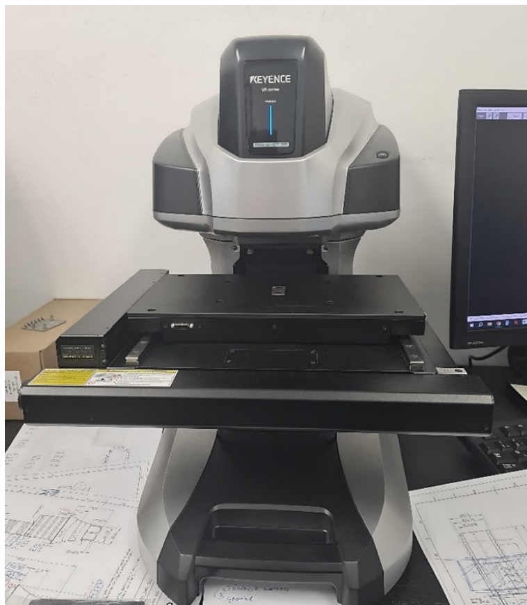
Slika 18. Uređaj za mjerenje hrapavosti površine Keyence VR-6000
