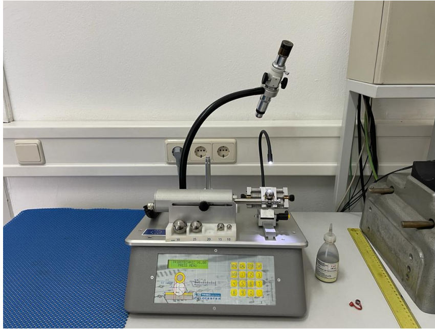
Slika 6.3 Kalotest TRIBOtechnic u Laboratoriju za inženjerstvo površina
