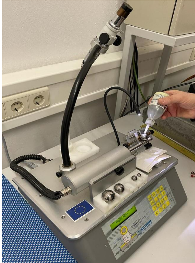
Slika 6.4 Ispitivanje debljine prevlake TiN kalotestom
