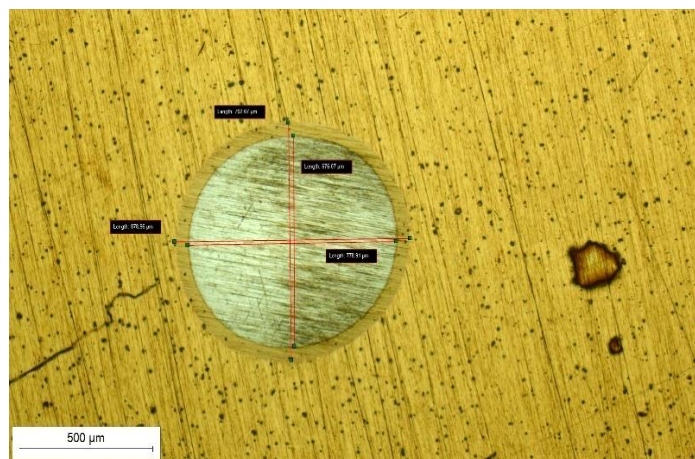
Slika 6.5 Otisak kuglice nakon provedenog kalotesta
