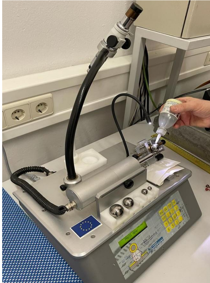
Slika 6.4 Ispitivanje debljine prevlake TiN kalotestom
