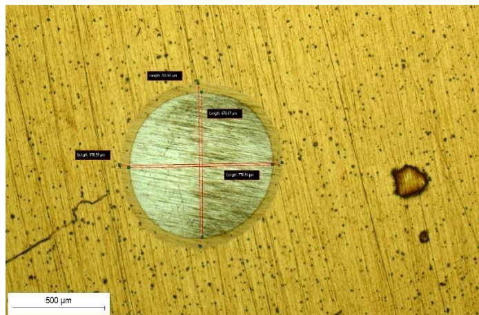
Slika 6.5 Otisak kuglice nakon provedenog kalotesta
