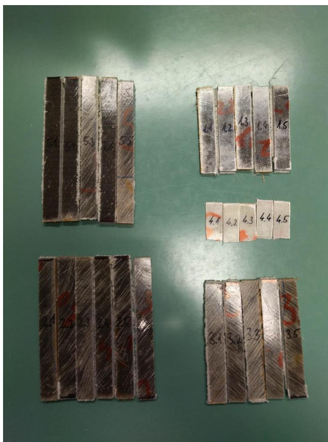
Slika 27. Prikaz ispitnih tijela za savojno ispitivanje
