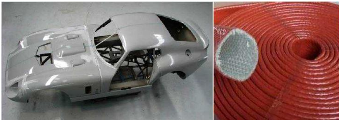
Slika 5. Lijevo: karoserija automobila od staklenih vlakana; Desno: izolacija [8]
