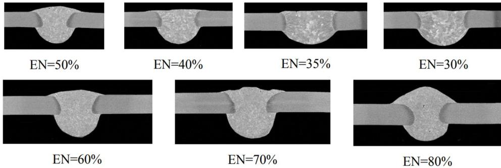
**Slika 8. Utjecaj visokog EN omjera na geometriju zavara [11]**
