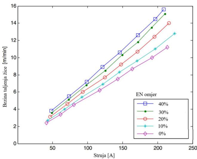
Slika 9. Ponašanje brzine taljenja žice u ovisnosti o EN omjeru [4]
