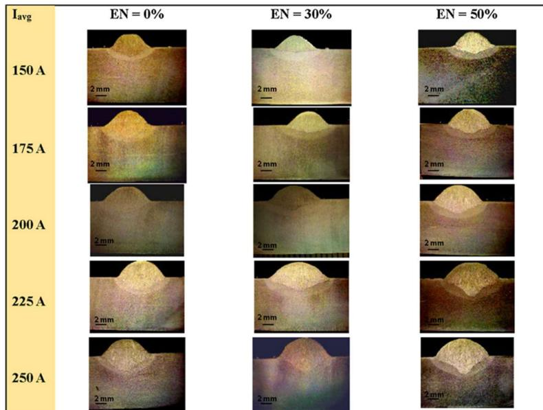
Slika 11. Utjecaj EN omjera i struje na zavarivanje debelih materijala [32]
