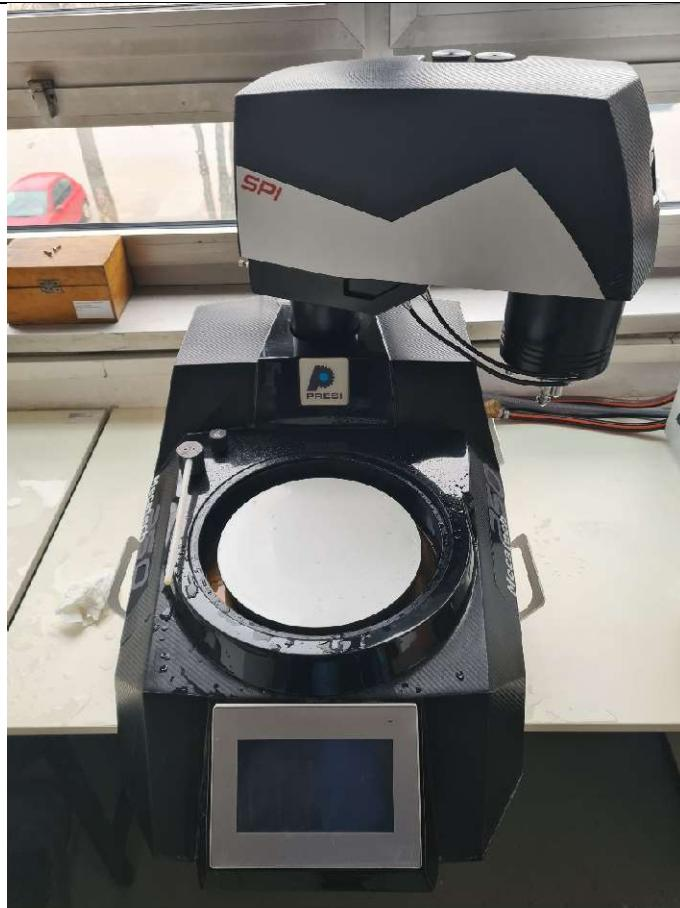
**Slika 25. Mecatech 250, stroj za poliranje**
