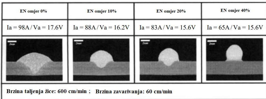
**Slika 7. Utjecaj EN omjera na penetraciju [13]**
