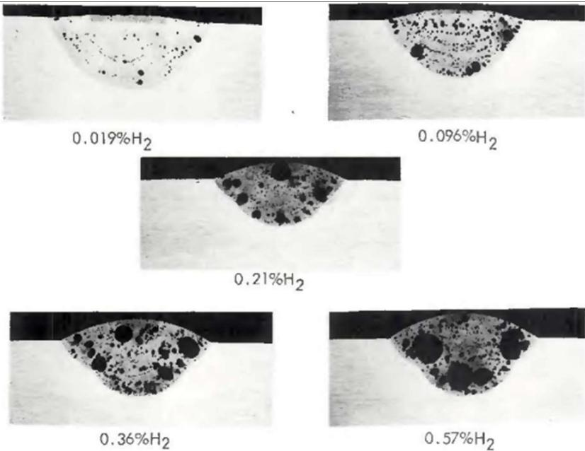
**Slika 16. Primjer utjecaja vodika na mikrostrukturu aluminijske legure [21]**
