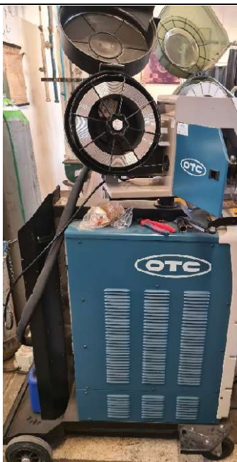
Slika 23. Welbee Inverter W400 s dodatnim materijalom
