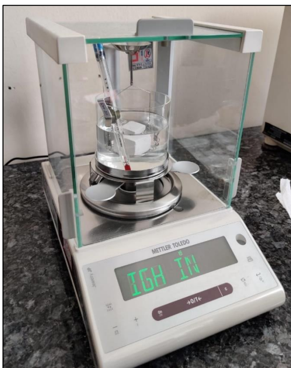
Slika 24. Arhimedova vaga Mettler Toledo
