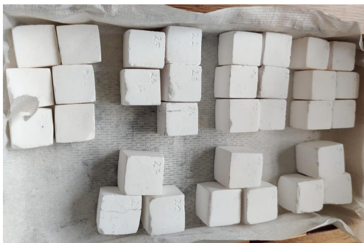
Slika 22. Sirovci nakon obrade brušenjem
