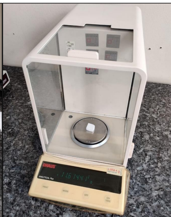
Slika 25. Analitička vaga Ohaus AP250D
