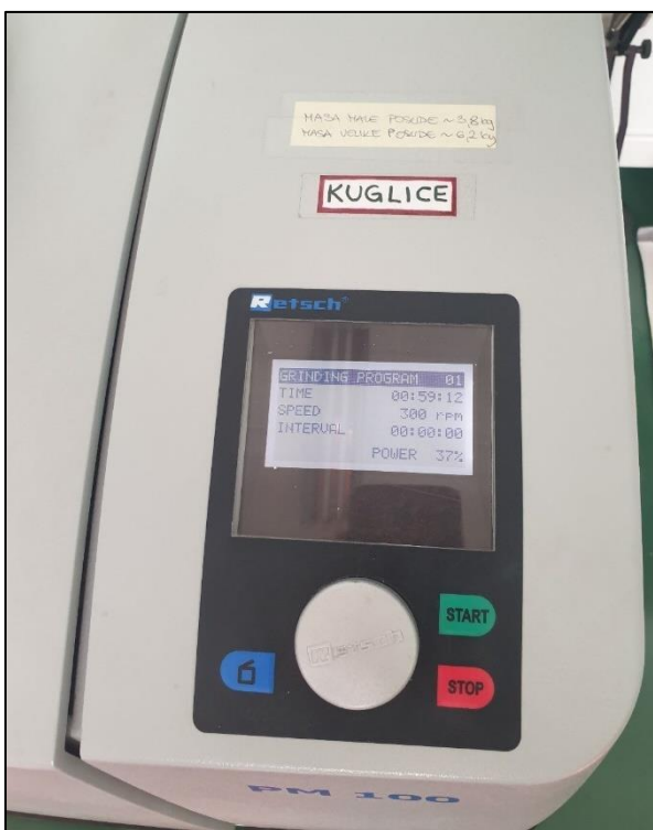
Slika 19. Režim miješanja kugličnim mlinom
