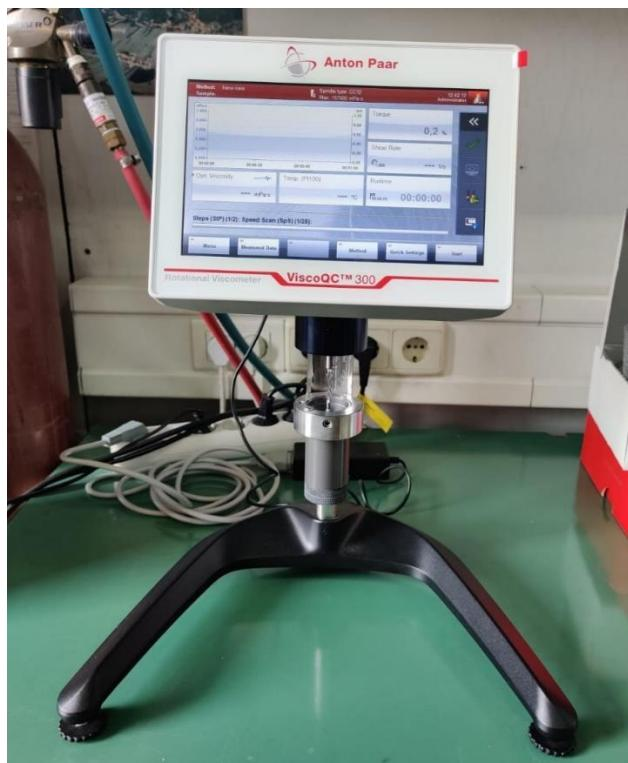
Slika 20. Rotacijski viskozimetar – Anton Paar ViscoQC 300
