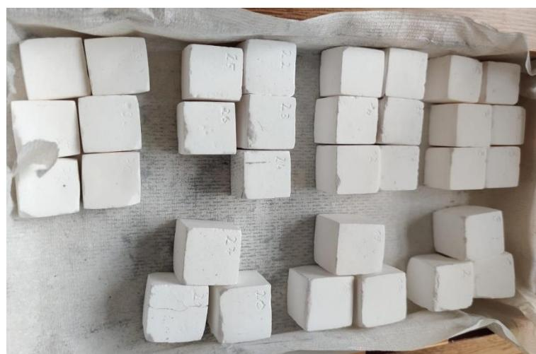
Slika 22. Sirovci nakon obrade brušenjem
