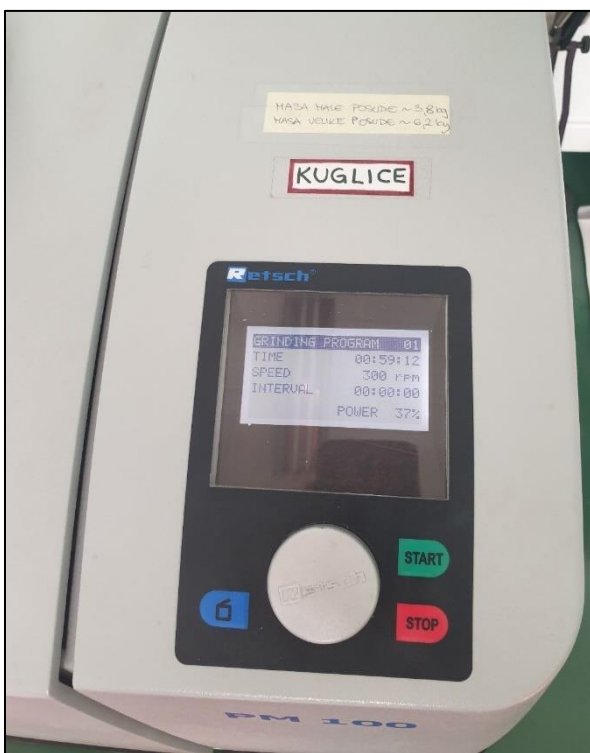
Slika 19. Režim miješanja kugličnim mlinom
