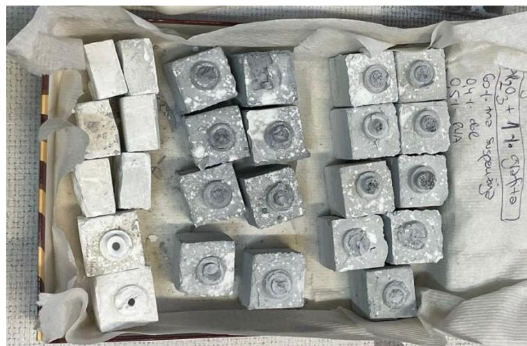
Slika 21. Sirovci izvađeni iz gipsanih kalupa nakon sušenja
