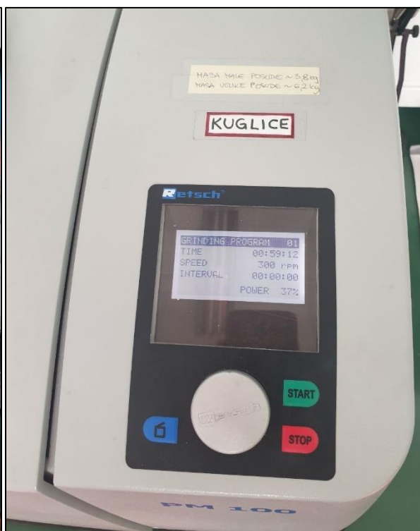
Slika 19. Režim miješanja kugličnim mlinom
