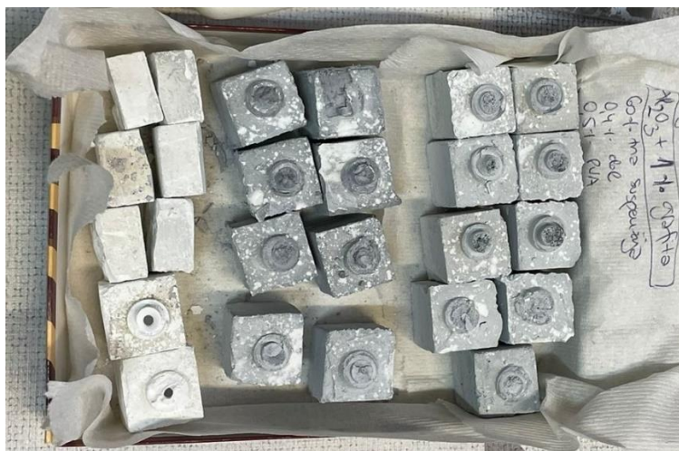
Slika 21. Sirovci izvađeni iz gipsanih kalupa nakon sušenja
