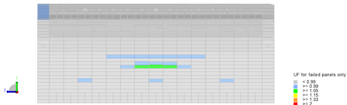
Slika 6-29 Istaknut prikaz pojedinih dijelova konstrukcije koji imaju nepodobni
