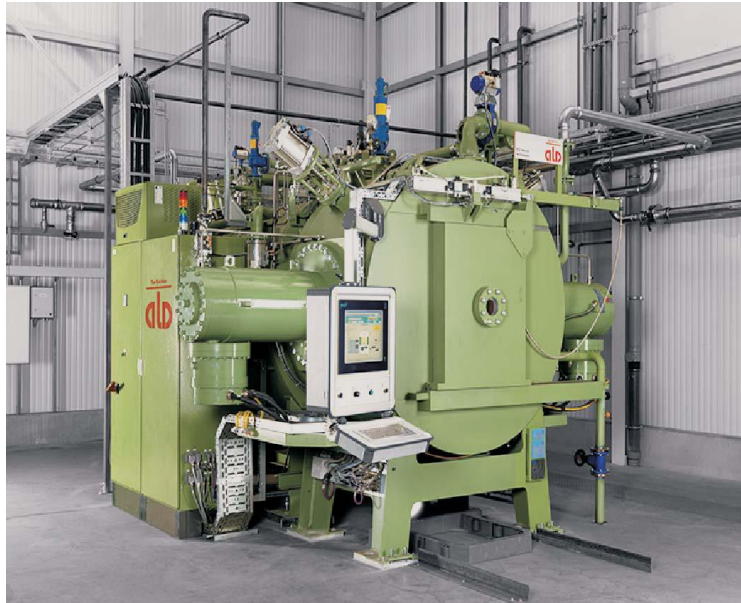
Slika 28. Horizontalna dvokomorna vakuumska peć [9]
