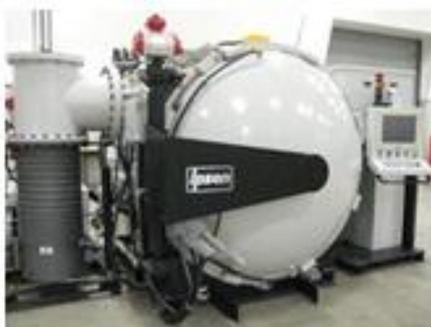
Slika 22. Vakuumaska peć za postupke lemljenja tvrtke Ipsen (Titan Type-6) [1]
