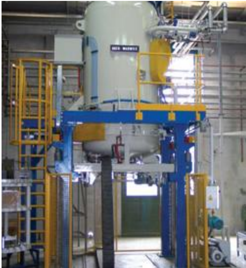
Slika 33. Vertikalna vakuumska peć sa spuštajućim dnom [9]
