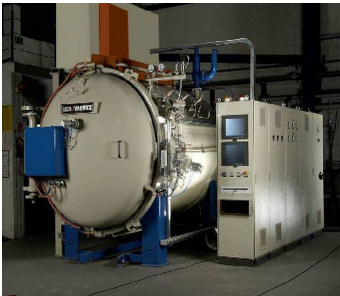
Slika 26. SECO/WARWICK horizontalna jednokomorna vakuumska peć [9]
