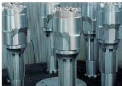
Slika 24. Predmeti obrađeni u vakuumskoj peći imaju metalni sjaj [5]
